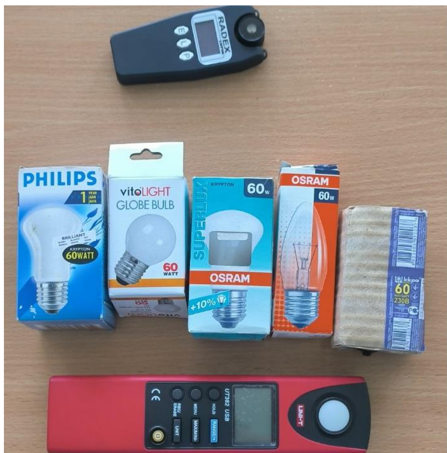
Рисунок 3.1 – Експериментальне дослідження характеристик ламп розжарення.
