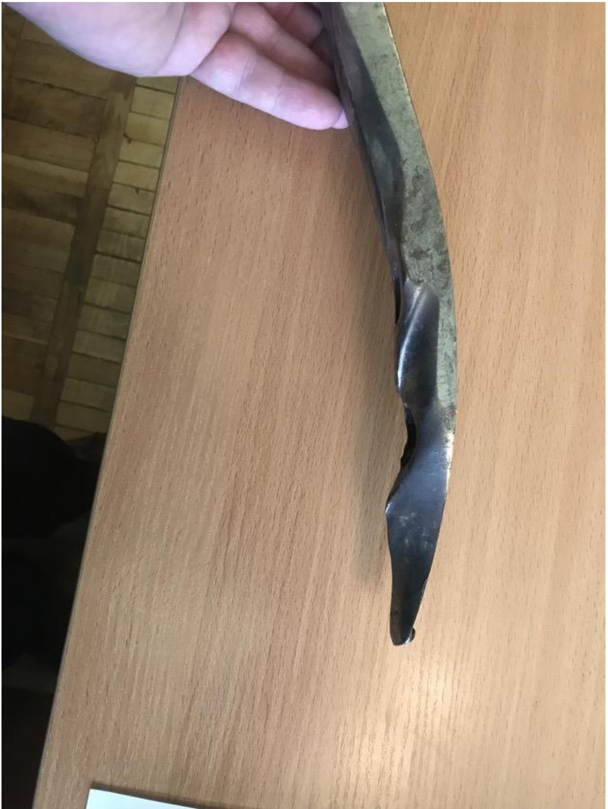
Рисунок 3.4 – Вигляд традиційного долота після експлуатації
