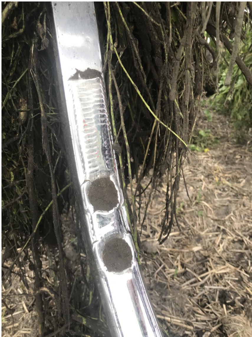
Рисунок 3.3 – Вигляд напавленого долота глибокорозпушувача Horsch Focus 7 після експлуатації. Огляд при заміні традиційних долот.
