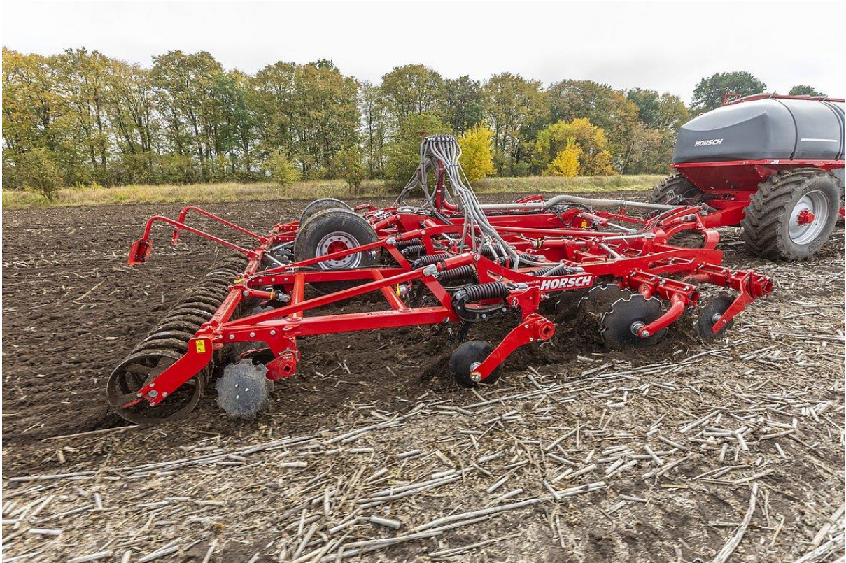
Рисунок 1.5 - Focus 7 MT з котком RingFlex для адресного внесення добрив до 500 кг/га
