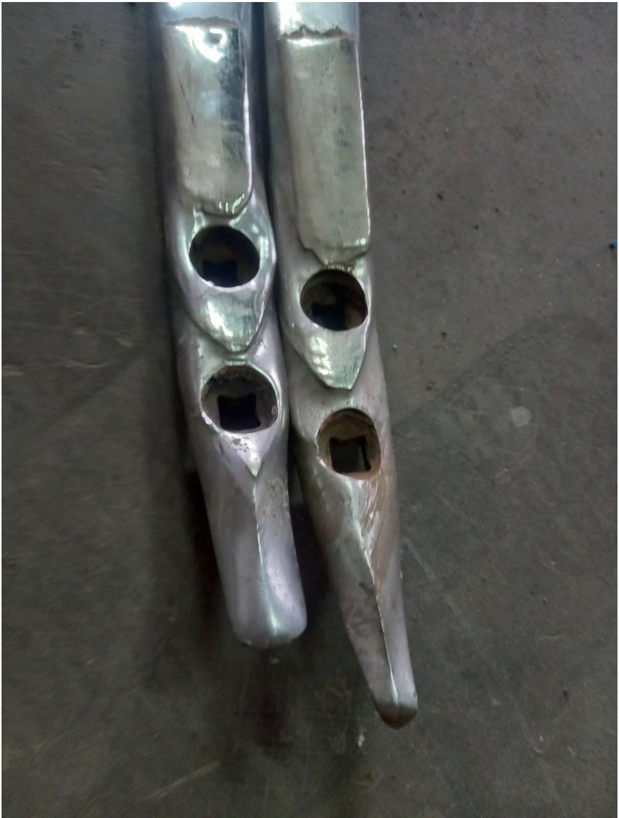
Рисунок 3.4 – Вигляд напавленого долота глибокорозпушувача Horsch Focus 7 після експлуатації. Огляд при другій заміні традиційних долот.
