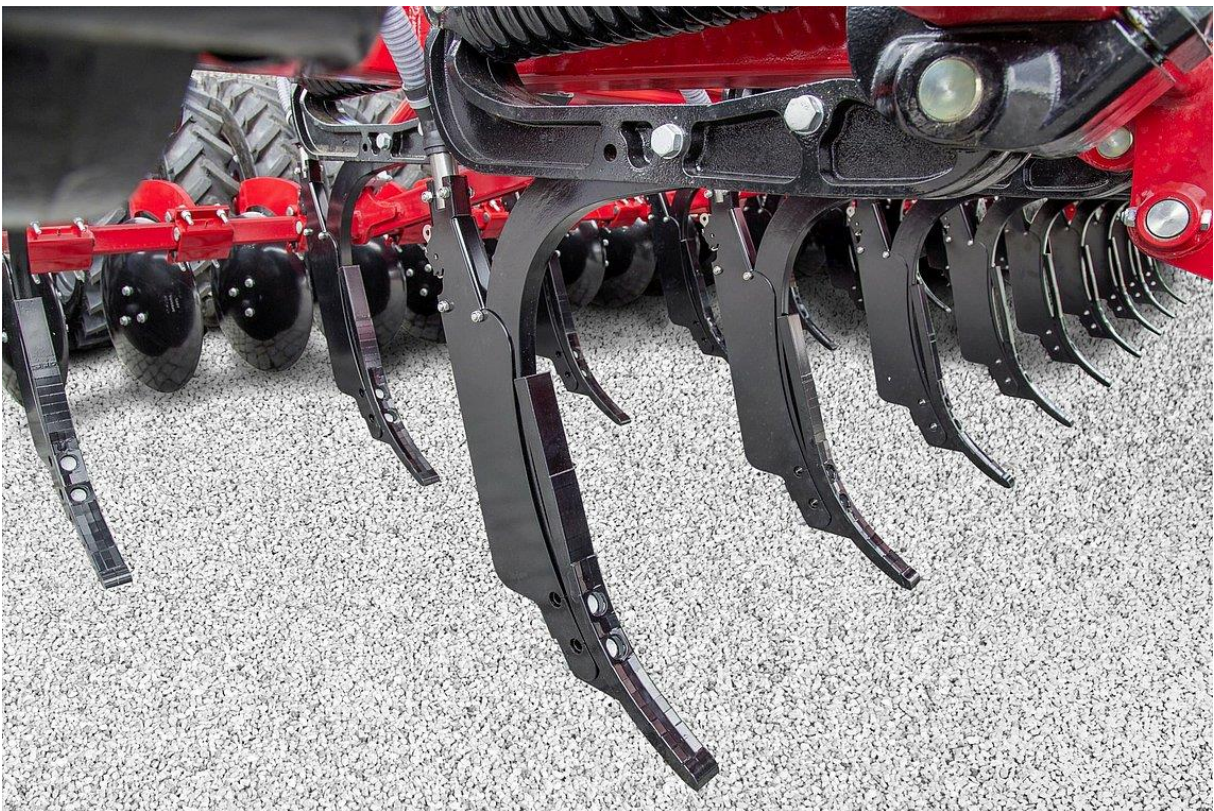
Рисунок 1.4 – Лапа HORSCH ULD+
