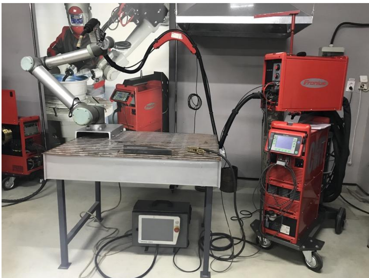
Рисунок 2.3 – Загальний вигляд установки для нанесення зносостійкого покриття.
