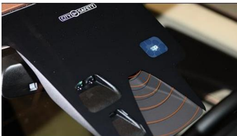
Рисунок 1.8. Блок засобів технічного зору системи City Safety
