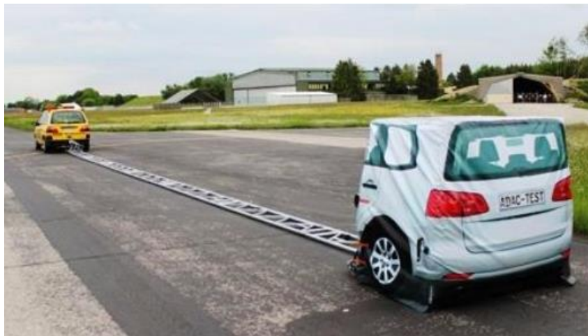
Рисунок 1.12. Автомобіль-перешкода (тестовий протокол EuroNCAP ver. 1.0) [24]
