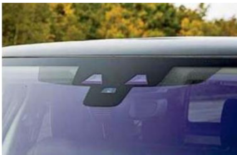
Рисунок 1.9. Стереокамери системи Autonomous Emergency Braking
