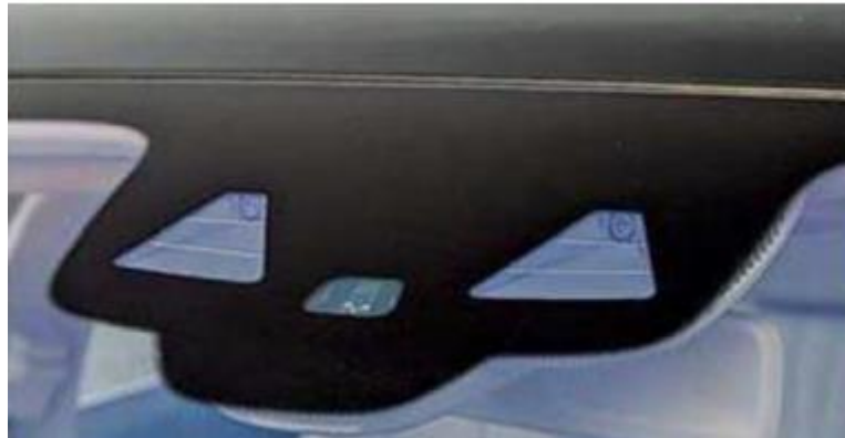
Рисунок 1.6. Стереокамери системи Collision Prevention Assist Plus
