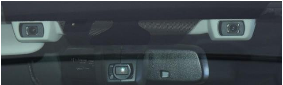
Рисунок 3.13. Стереокамера системи EyeSight автомобіля Subaru XV
