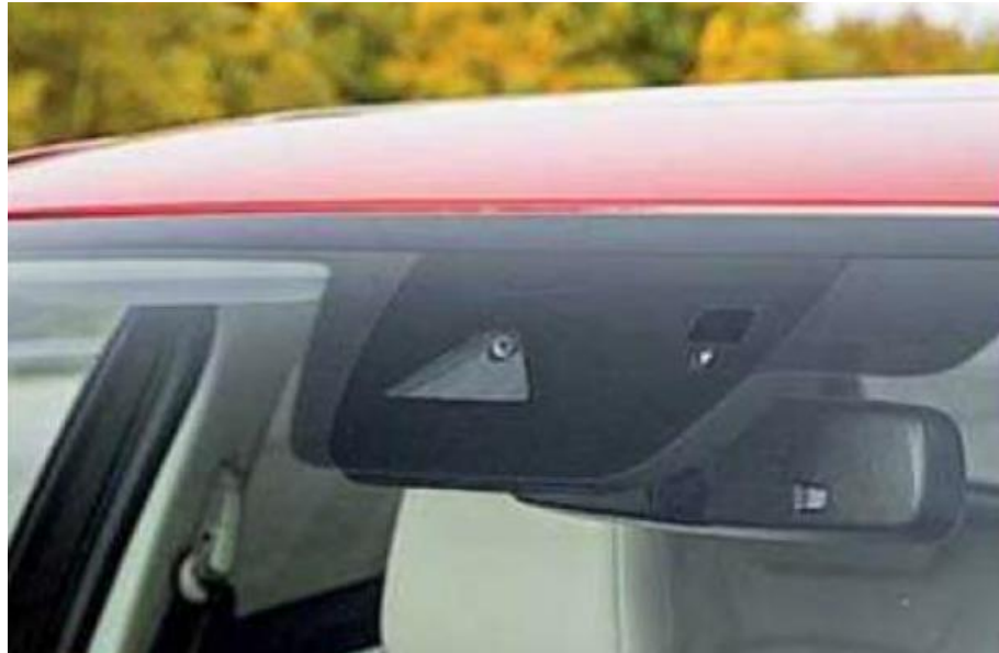
Рисунок 1.10. Камера системи Smart City Brake Support
