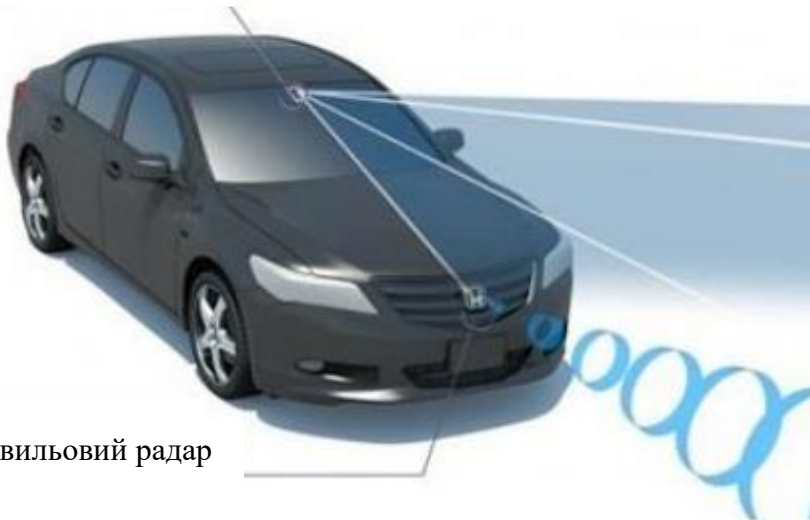
Рисунок 1.3. Розташування приладів технічного зору на автомобілі
