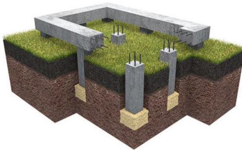
Рис. 5.7 Стівпчастий монолітний фундамент
