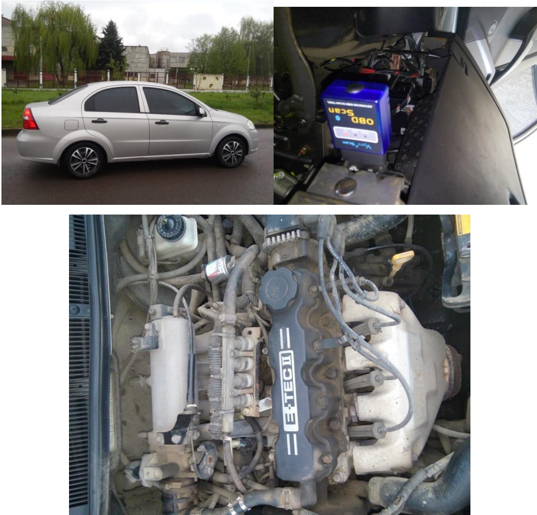
Рисунок 3.6 - Двигун E-TEC II 86 з системою подачі газу Stag-4 PLUS
