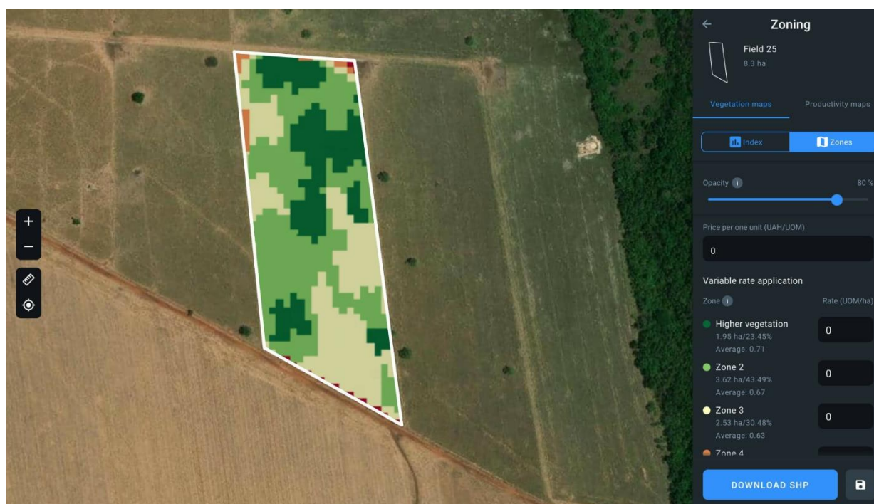
Рис. 4.1. Зонування поля зернових для диференційованого внесення добрив (рисунок з сайту eos.com).
