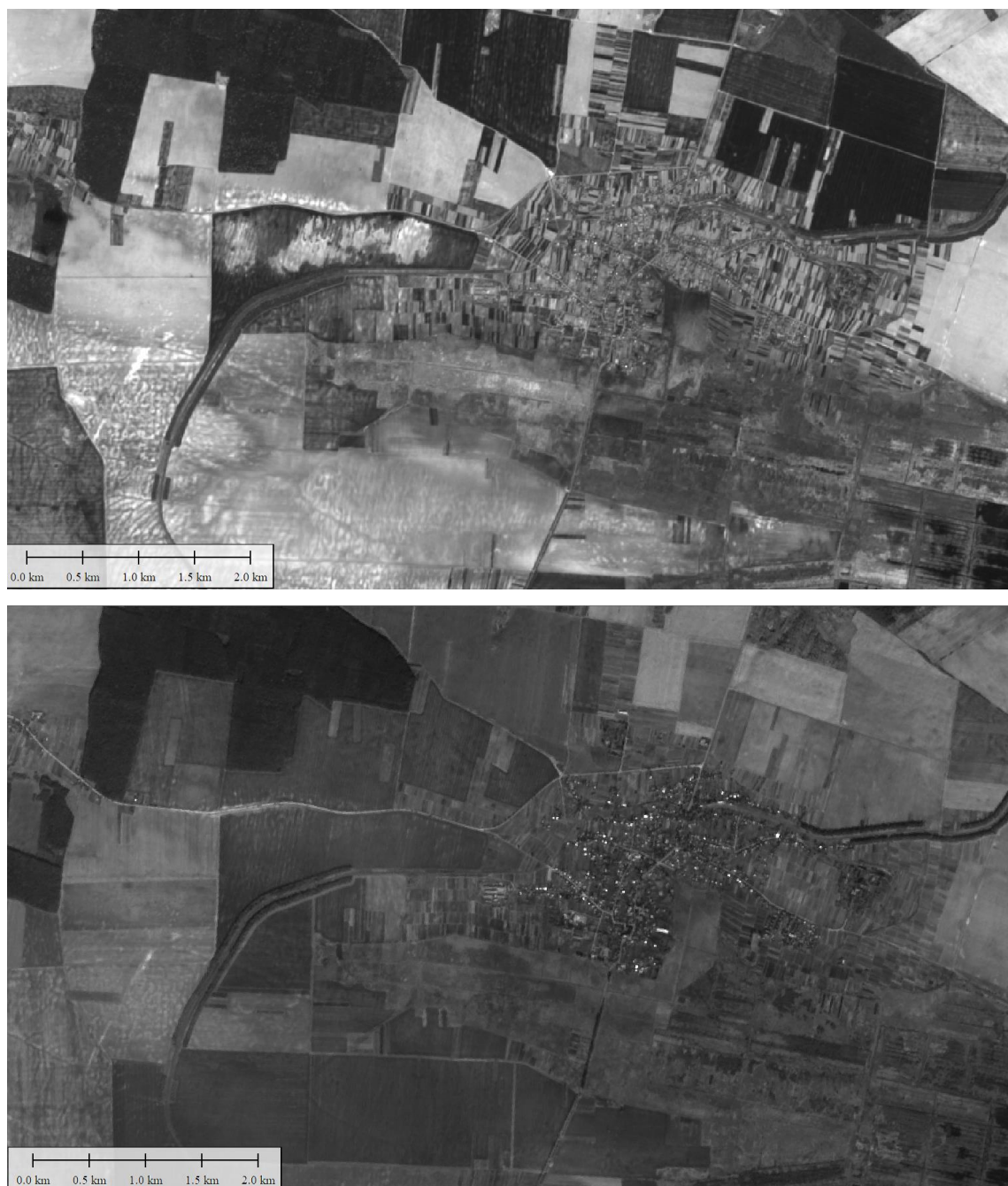
Рис. 3.7. зверху – рівень опрацювання 1С, внизу – зображення рівня 2А на основі 1С (канал В04, с. Стоянів, Львівська область).
