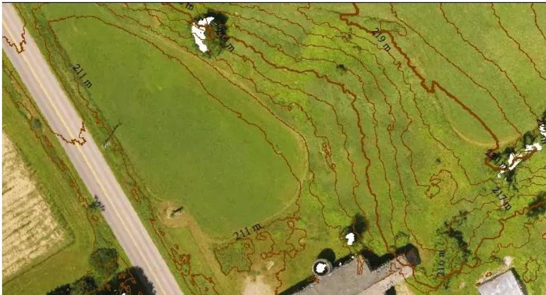
Рис.3.3 Global Mapper Pro генерує контурні лінії на основі даних рельєфу або хмари точок
