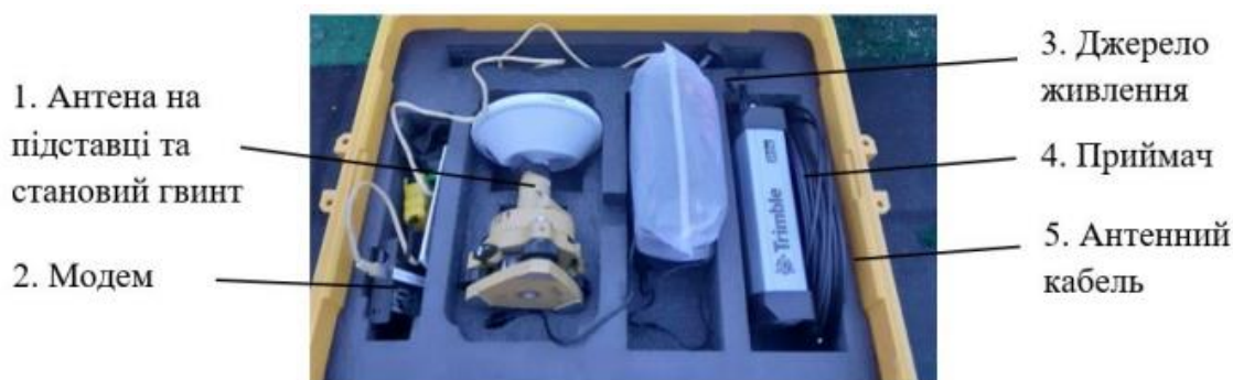
Рис. 1.2. Скомплектована мобільна базова станція
