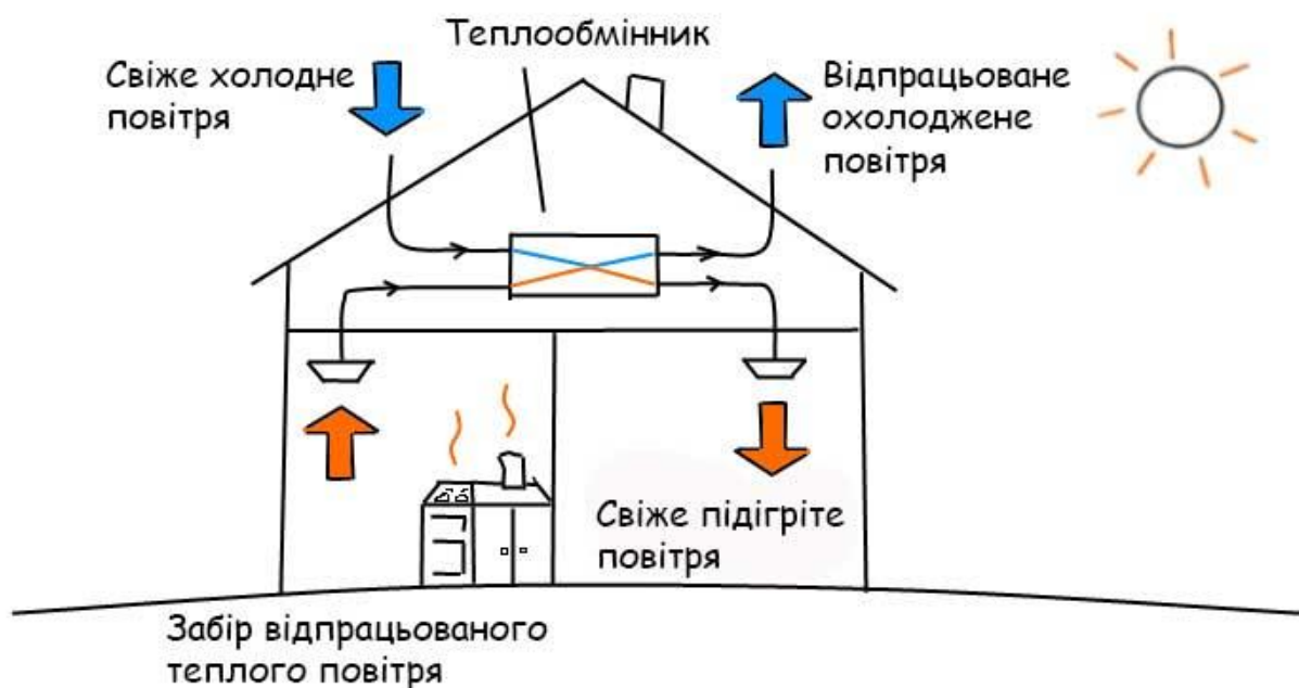
Рисунок 3.8 – Схема роботи звичайного рекуператора повітря
