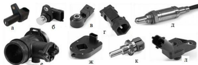
Рисунок 2.1 – Електронні давачі двигуна з ЕБК:
