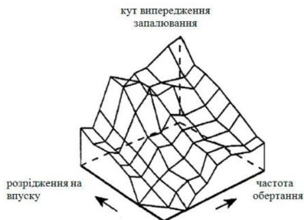
Рисунок 2.3 – Схема регулювання кута випередження запалювання у двигунах із іскровим запалюванням.
