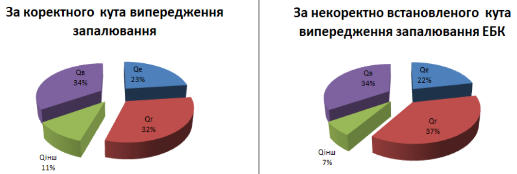
Рисунок 3.6 – Порівняльний тепловий баланс бензинового двигуна.
