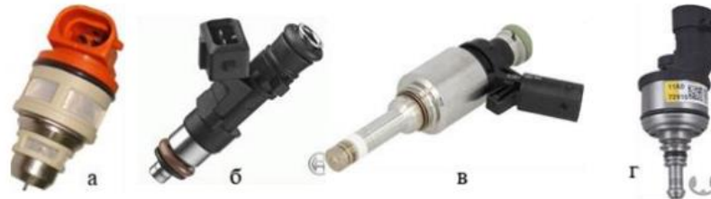
Рисунок 2.4 - Паливні форсунки різного типу впорскування [13]: а – центральні; б – розподільні; в - безпосередні; г – для подачі газу.
