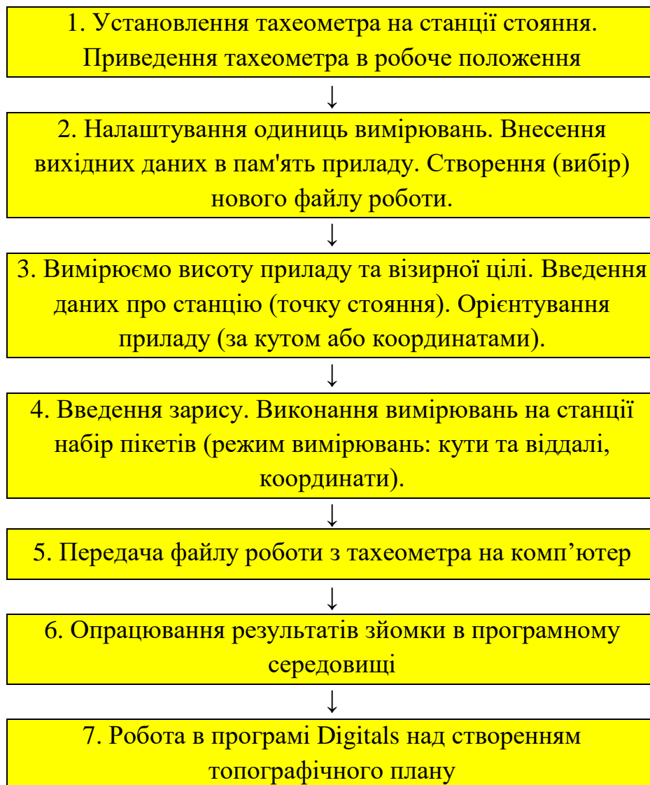
Рис. 2.1. Технологічна схема створення цифрового плану
