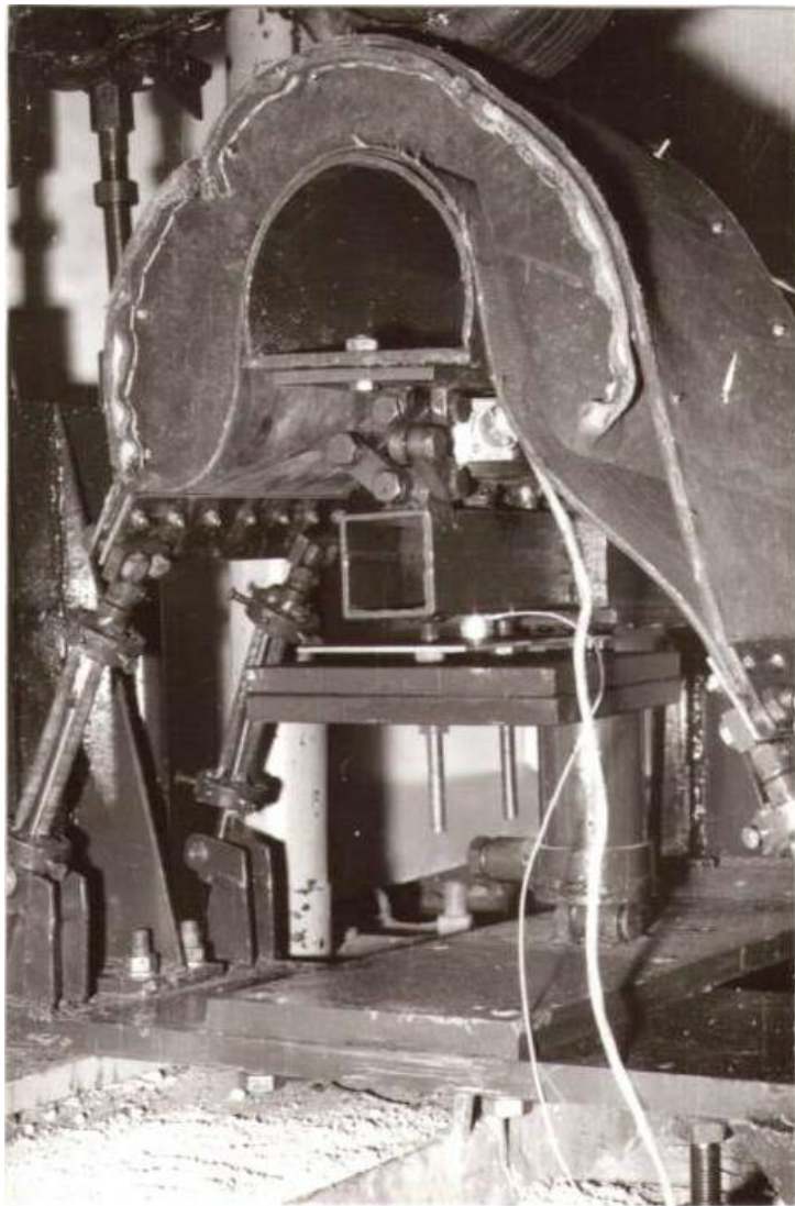
Рисунок 3.3 – Загальний вигляд акселерометра та месدوزи
