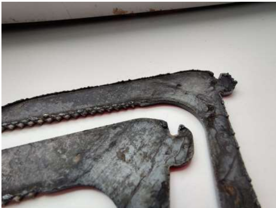
Рис. 1.8 Порівняння між якісною різкою і при недостатньому тиску
