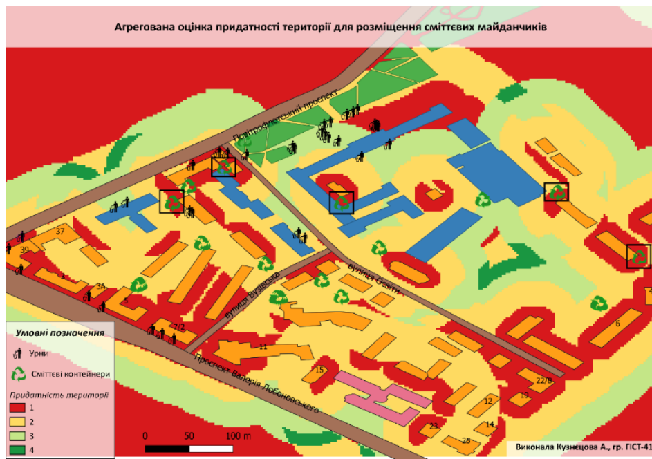
Рис 1. Порухення умов розташування сміттєвих контейнерів.
