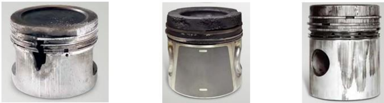
Рисунок 1.4 - Прогари поршнів циліндро-поршневої групи в наслідок оливного «голодування»
