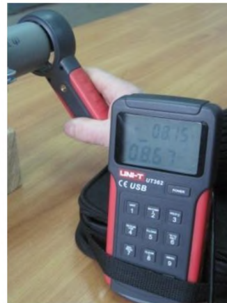
Рис. 1. Визначення швидкості повітряного потоку анемометром UT 362
