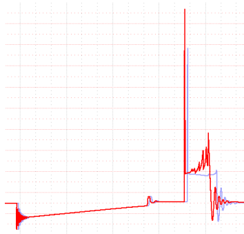
Рисунок 3.4 – Осцилограма за збільшеного зазору на контактах (підвищена пробивна напруга).
