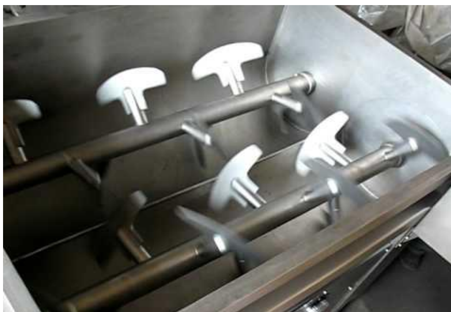
Рисунок 2.4 - Фаршесмішувач з подвійними валами
