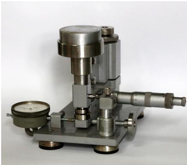
Рис. Пристрій для дослідження сили і коефіцієнта зчеплення насіння з рифленими поверхнями.
