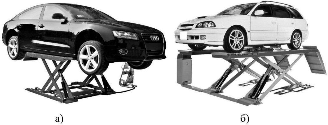
Рисунок 1.6 – ножичний підйомник а) коротка платформа б) довга платформа
