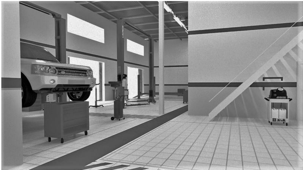
Рисунок 1.2 – планування і вигляд сучасного посту ремонту з обладнанням
