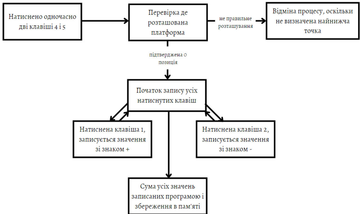
Рисунок 3.7. – Схема алгоритму для за програмування висоти підйому
