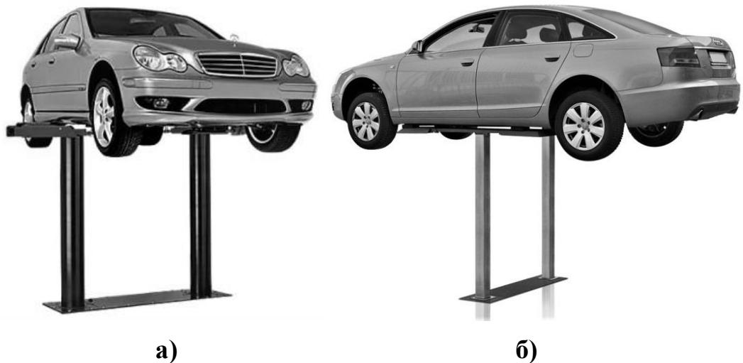
Рисунок 1.7 – плунжерний підйомач а) з лапами б) з платформою
