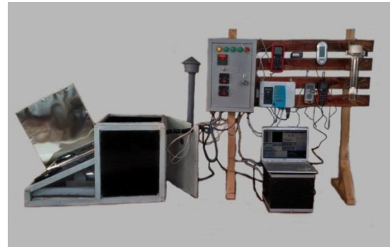
Рис. Геліосушарка з тепловим акумулятором та плоским дзеркальним концентратором: а – конструктивно-технологічна схема; б – загальний вигляд; 1 – вхідний канал; 2 – вентилятор з нагрівачем; 3 – повітропровід; 4 – повітряний колектор; 5 – теплоакумулювальний матеріал; 6 – сушильна камера; 7 – витяжний канал; 8 – решета; 9 – дзеркальний концентратор; 10 – заслінка.
