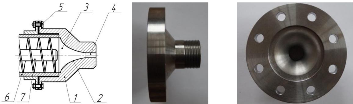
Рис. Формувальна головка преса рослинних матеріалів: 1 – корпус головки; 2 – внутрішня поверхня головки (псевдосфера); 3 – робоча камера; 4 – вихідний циліндричний отвір; 5 – кріплення формувальної головки; 6 – корпус преса; 7 – шнек преса.
