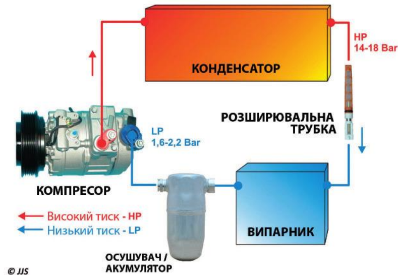
Рисунок 1.8 – Схема роботи системи кондиціонування автомобіля
