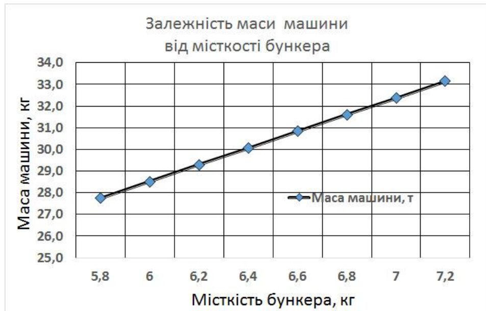
Рисунок 3.3 – Залежність маси машини від місткості її бункера
