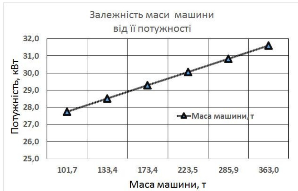
Рисунок 3.4 – Взаємозв'язок між масою машини і потужністю її двигуна
