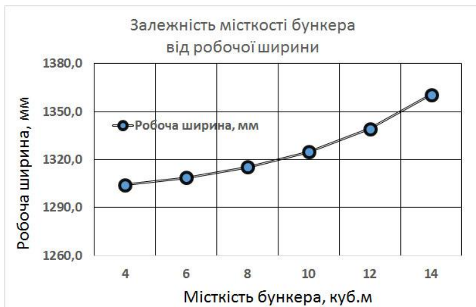
Рисунок 3.5 – Залежність місткості її бункера і робочою шириною технологічного обладнання для обробки поверхні.
