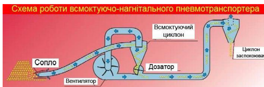
Рисунок 2.2 - Схема роботи всмоктуючо-нагнітального пневмотранспортера
