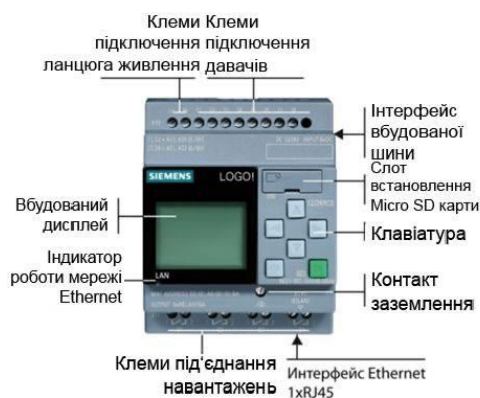
Рисунок 2.6 - Розміщення клем та слотів на контролері Siemens LOGO!
