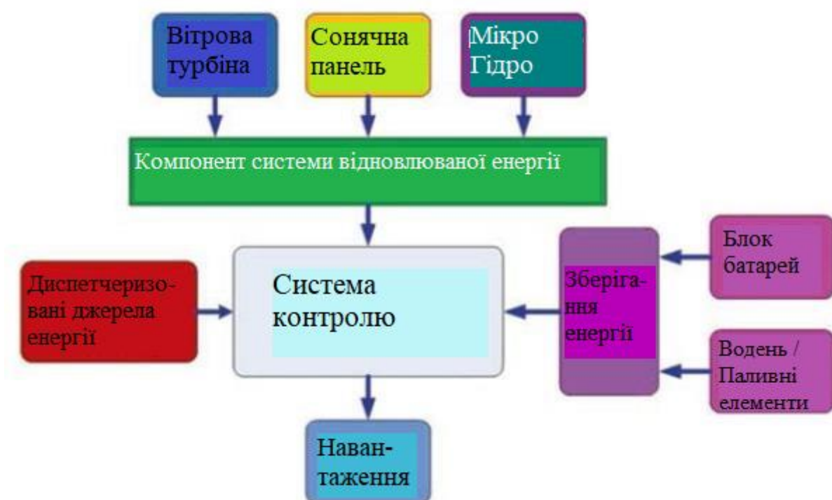
Рис. 3.3 – Блок-схема автономної гібридної енергетичної системи
