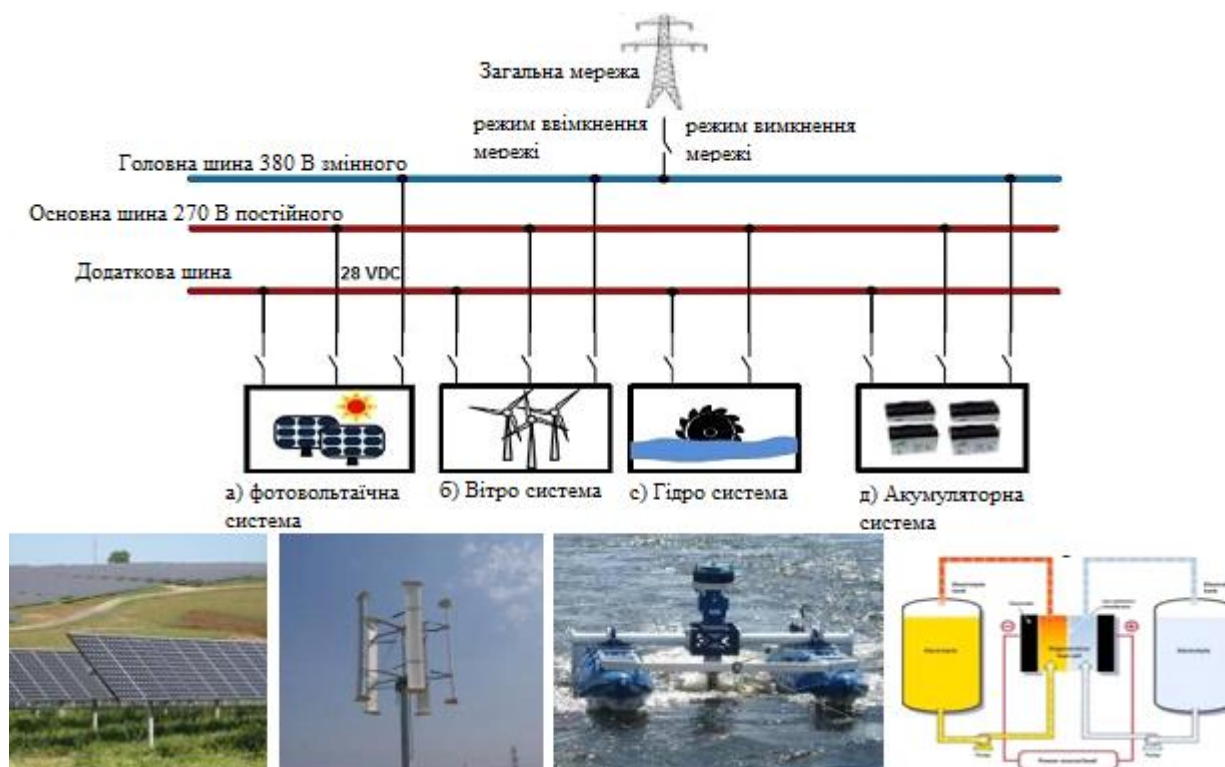
Рис. 3.4 – Топологія мікромережі гібридної системи енергозабезпечення особистого селянського господарства з використанням відновлюваних джерел енергії
