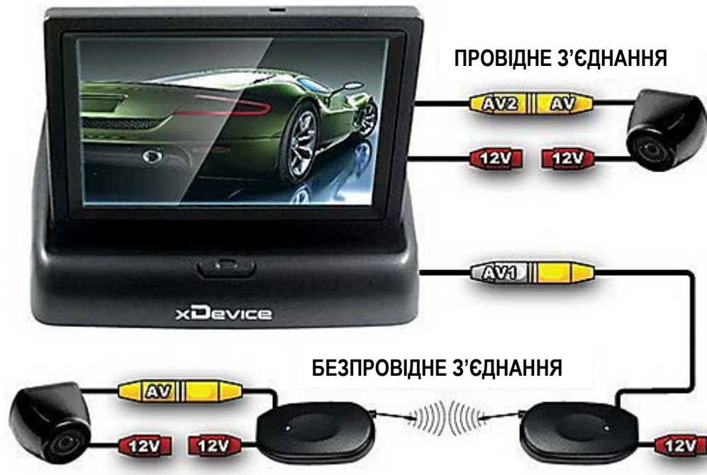
Рисунок 1.16 – Способи з'єднання камер з монітором
