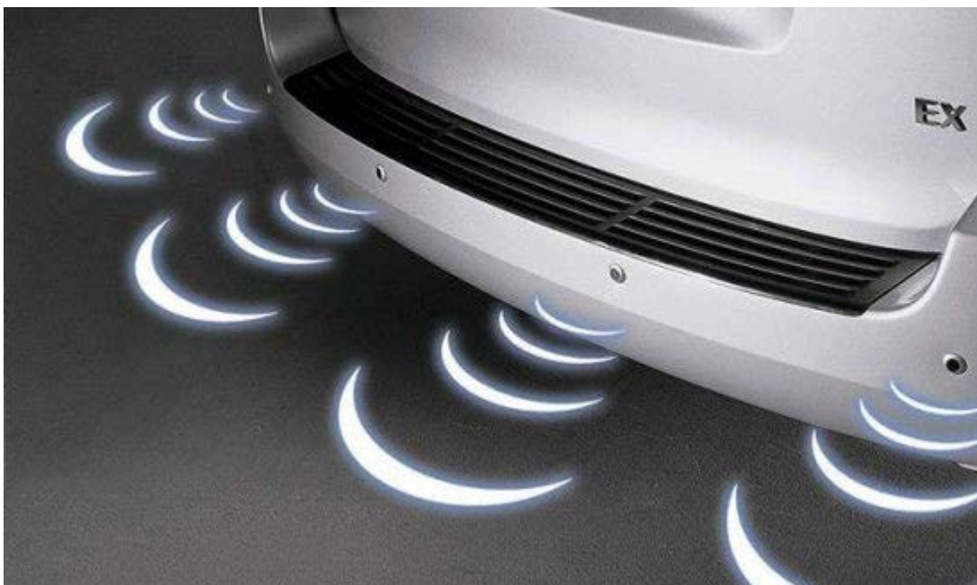
Рисунок 1.2 – Зона дії парктроніка з 4-ма датчиками
