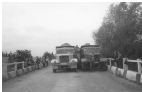
Рис. 10.3. Одностороннє ( a ) і симетричне ( b ) завантаження моста впоперек прольоту
