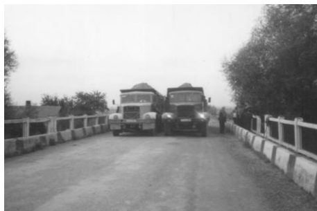
Рис. 10.3. Одностороннє ( a ) і симетричне ( b ) завантаження моста впоперек прольоту
