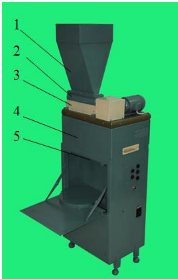
Рис. 4.6. Загальний вигляд плющилки насіння олійних культур: 1 – завантажувальний бункер; 2 – дозатор; 3 – формувач потоку насіння; 4 – вальцьовий плющильний робочий орган; 5 – відвідний лоток.
