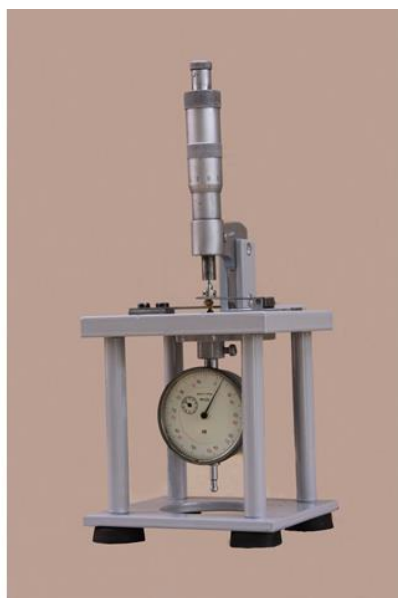
Рис. 1.6. Пристрій для дослідження насінин на стиск ( а – схема; б – загальний вигляд): 1 – робочий стіл; 2 – стійка; 3 – вимірювальна частина мікрометра; 4 – консольна динамометрична балка; 5 – індикатор; 6 – проставка; 7 – притискна пластина; 8 – голчастий упор; 9 – кронштейн; 10 – блок регулювальних прокладок; 11 – досліджувана насінина.
