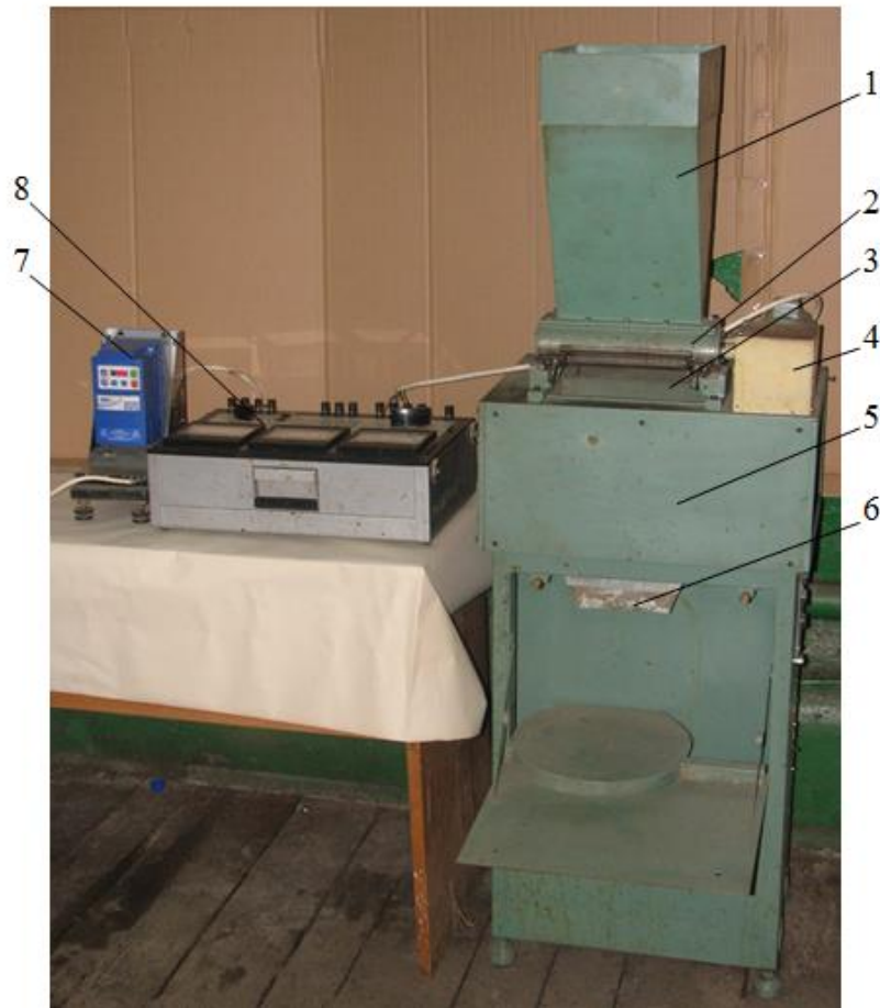
Рис. 4.4. Лабораторна установка для дослідження плющення насіння олійних культур: 1 – завантажувальний бункер; 2 – дозатор; 3 – формувач потоку насіння; 4 – привід дозатора; 5 – корпус вальцьового плющильного робочого органа; 6 – відвідний лоток; 7 – перетворювач частоти струму Lenze ESV222NO4TXB; 8 – комплект вимірювальний К-505.
