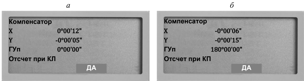
Рис. 4.35. До перевірки місця нуля компенсатора
