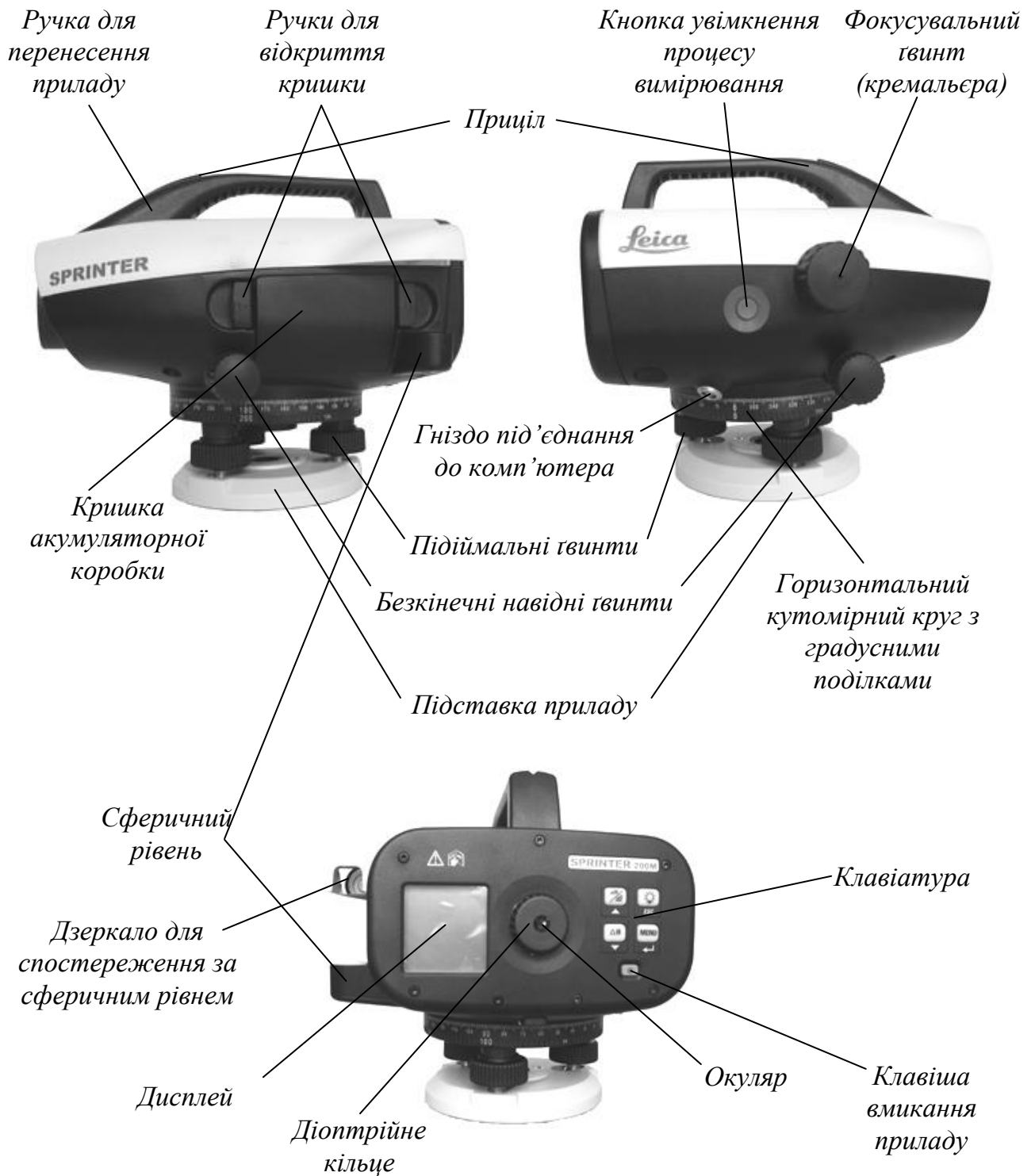
Рис.3.13. Загальний вигляд і будова нівеліра Sprinter 200M
