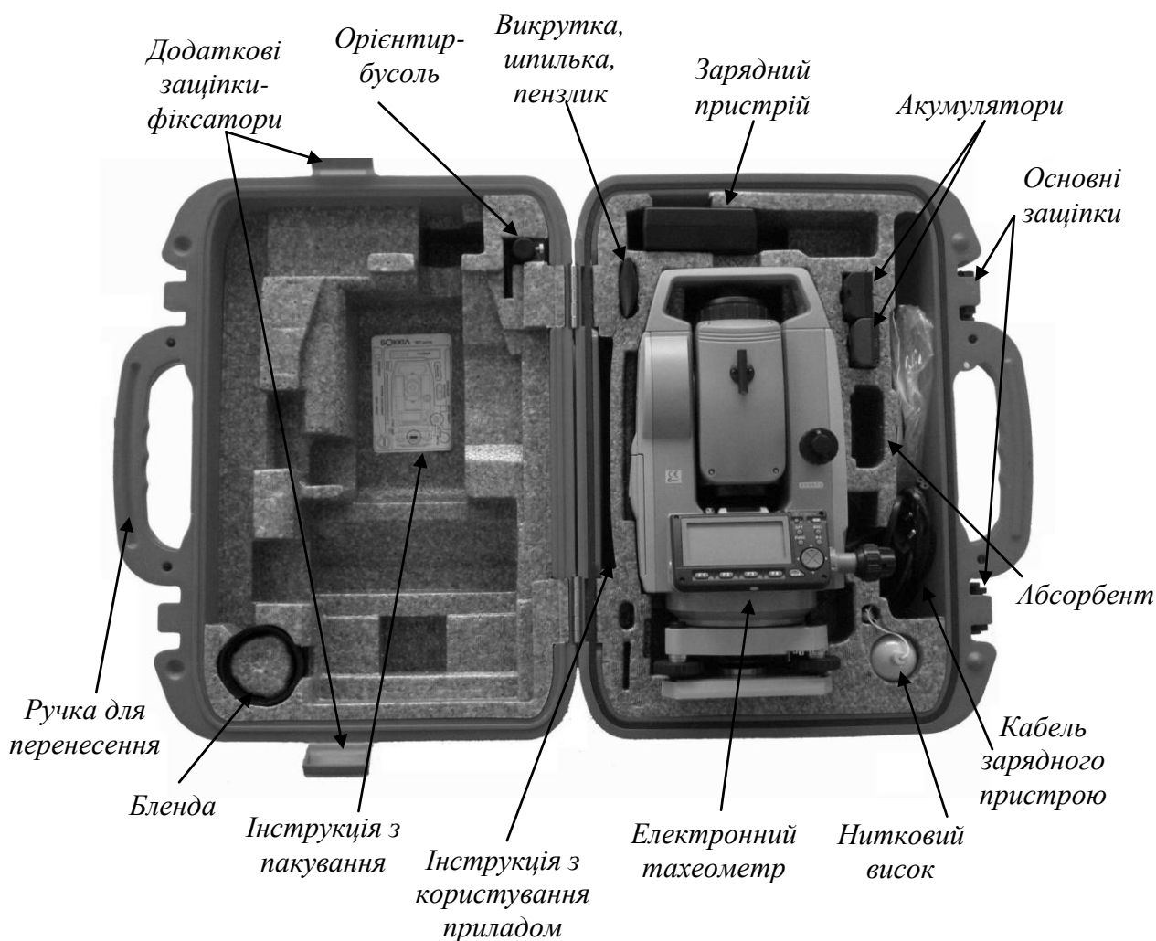
Рис.4.6. Електронний тахеометр Sokkia SET 610 та приладдя в пакувальній скриньці
