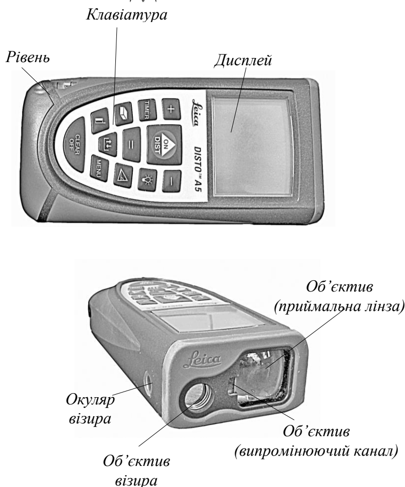
Рис. 2.4. Загальний вигляд і будова лазерного віддалеміра Leica DISTO A5
