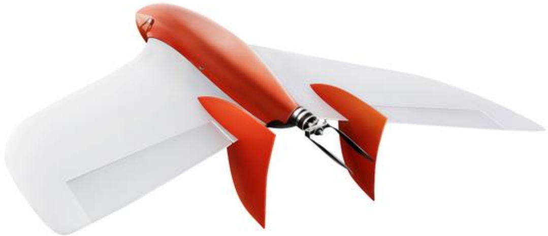
Рисунок 7.7 - Аерофотознімальний комплекс GeoScan 101
