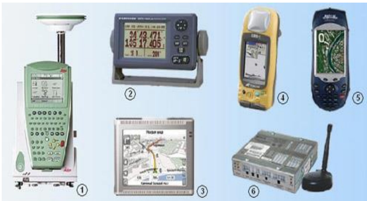
Рис. 6.6. Обладнання сегмента GPS-користувачів
