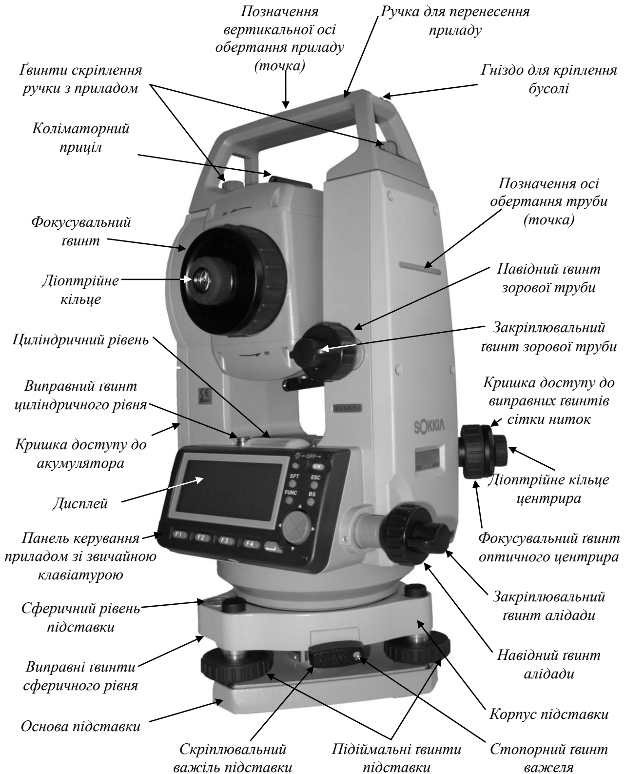
Рис. 4.14. Електронний тахеометр Sokkia SET 610.
