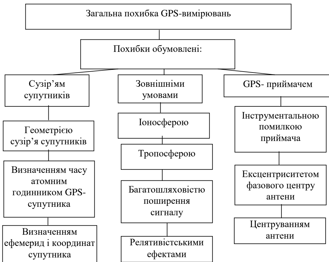
Рис. 6.8. Структура похибок, що виникають при GPS-спостереженнях Ці джерела похибок можна поділити на три групи (рис. 6.8), пов'язані із:
