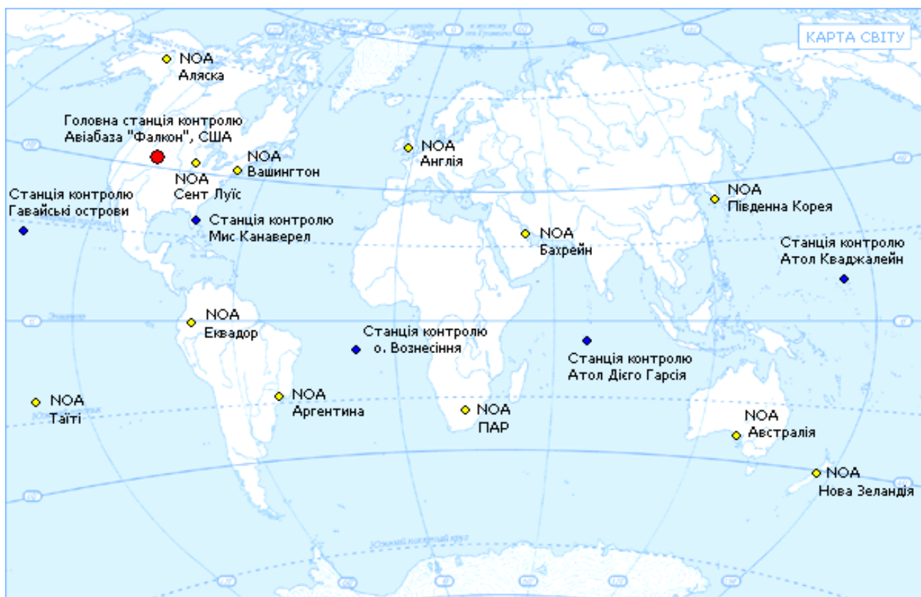
Рис. 6.5. Розташування контрольної станції та станцій спостереження GPS.
