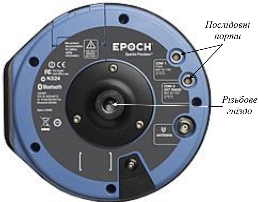
Рис. 6.29. Порти та гнізда приймача Epoch 35
