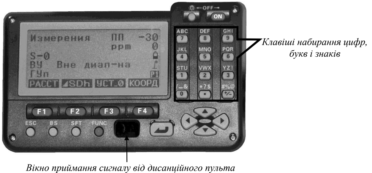
Рис. 4.18. Панель керування тахеометром Sokkia SET 610K.
