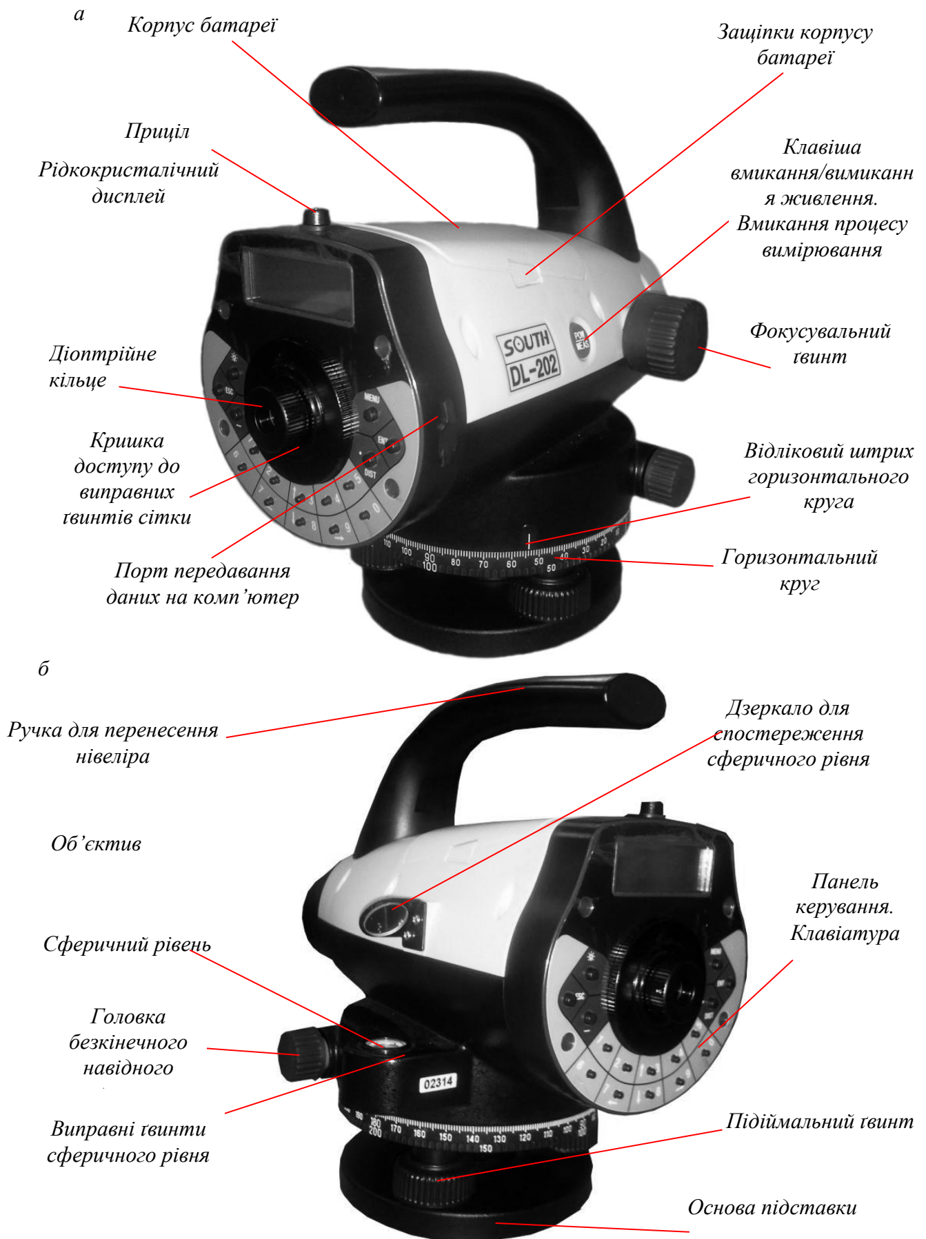
Рис. 3.8. Будова цифрового нівеліра South DL-202
