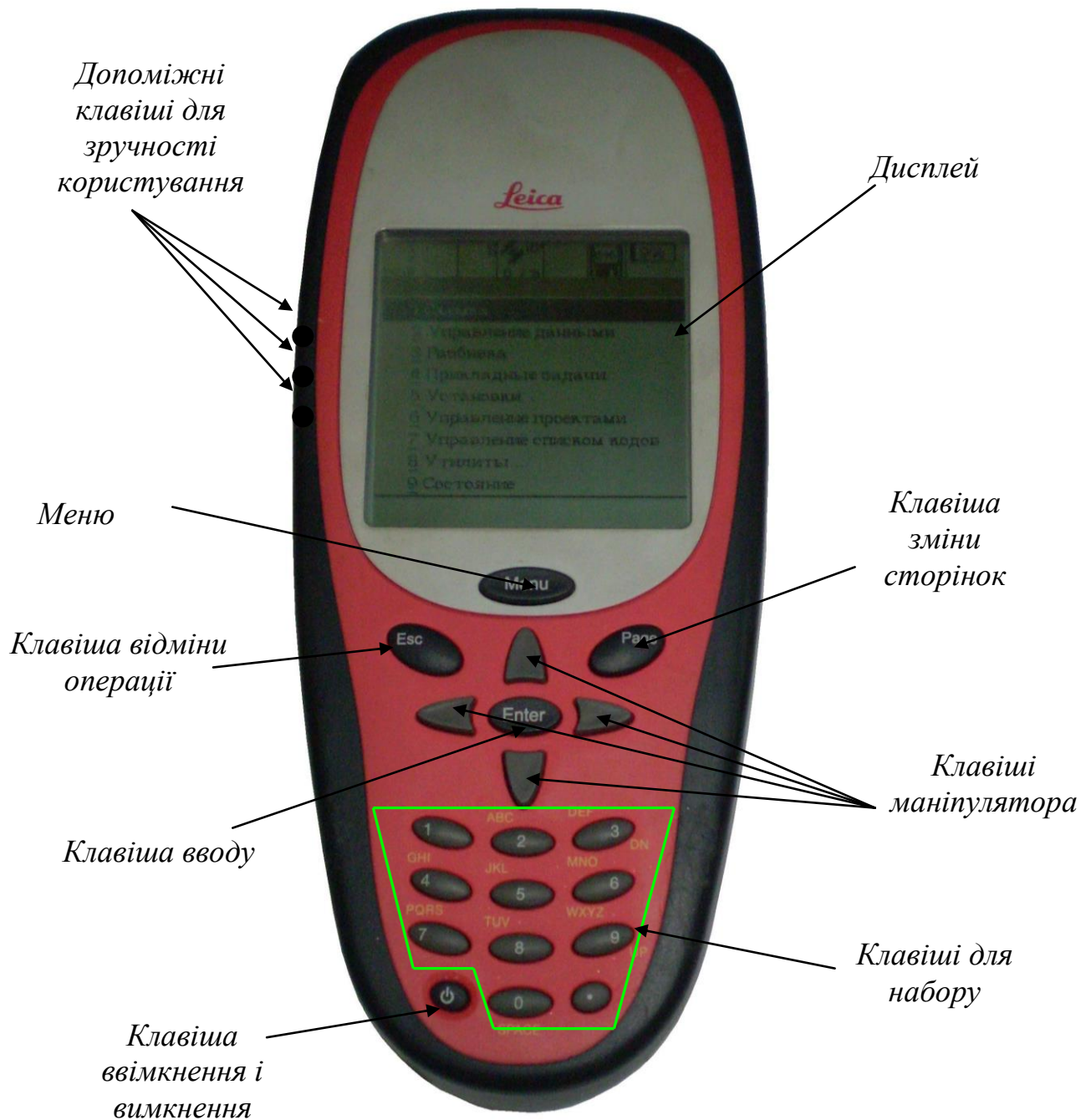
Рис. 6.17. Лицевий вигляд одночастотного приймача фірми Leica SR20.
