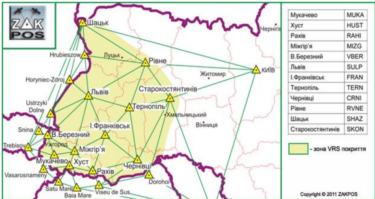
Рис.6.14. Схема розташування мережі UA-EUPOS/ZAKPOS станом на травень 2017 року [37].
