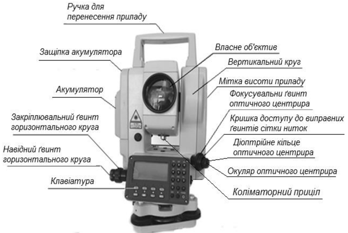
Рис. 4.58. Загальний вигляд тахеометра SOUTH NTS 352 R з боку об'єктива для КЛ
