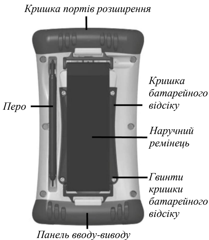
Рис. 6.33. Загальний вигляд контролера NOMAD 900 (вигляд ззаду)
