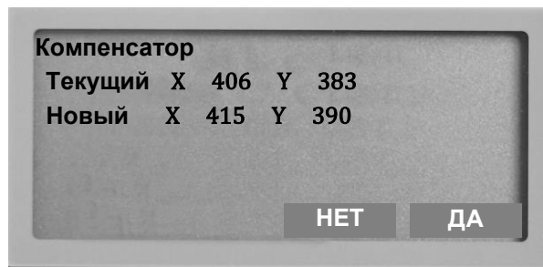
Рис. 4.36. Результат перевірки місця нуля компенсатора
