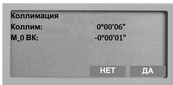
Рис. 4.38. Результат перевірки місця нуля та колімації
