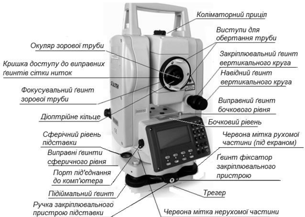
Рис. 4.59. Загальний вигляд тахеометра SOUTH NTS 352 R вид з боку окуляра для КЛ
