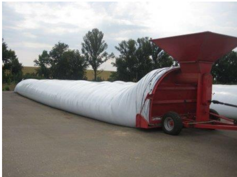
Рис. 9. Закладання зерна на зберігання в поліетиленові мішки-рукава
