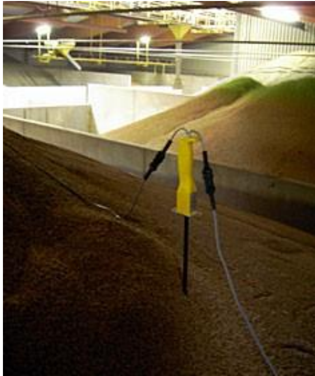
Рис. 21. Вимірювальний спос всередині зернового насипу
