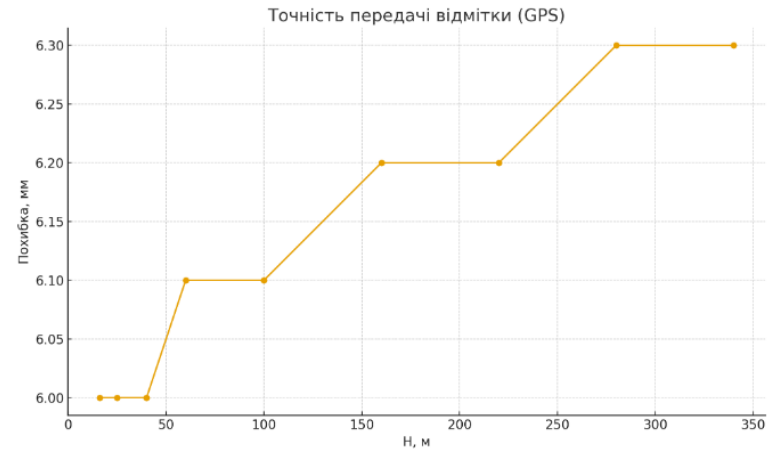
Рис. 1.17. Точність передачі планових координат та точність передачі відмітки (GPS)
