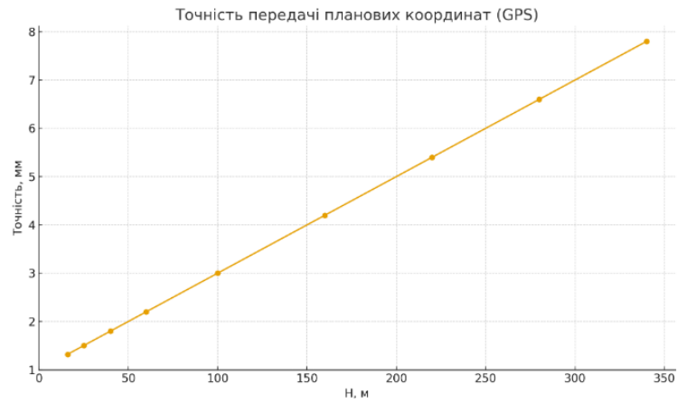
Рис. 1.17. Точність передачі планових координат та точність передачі відмітки (GPS)
