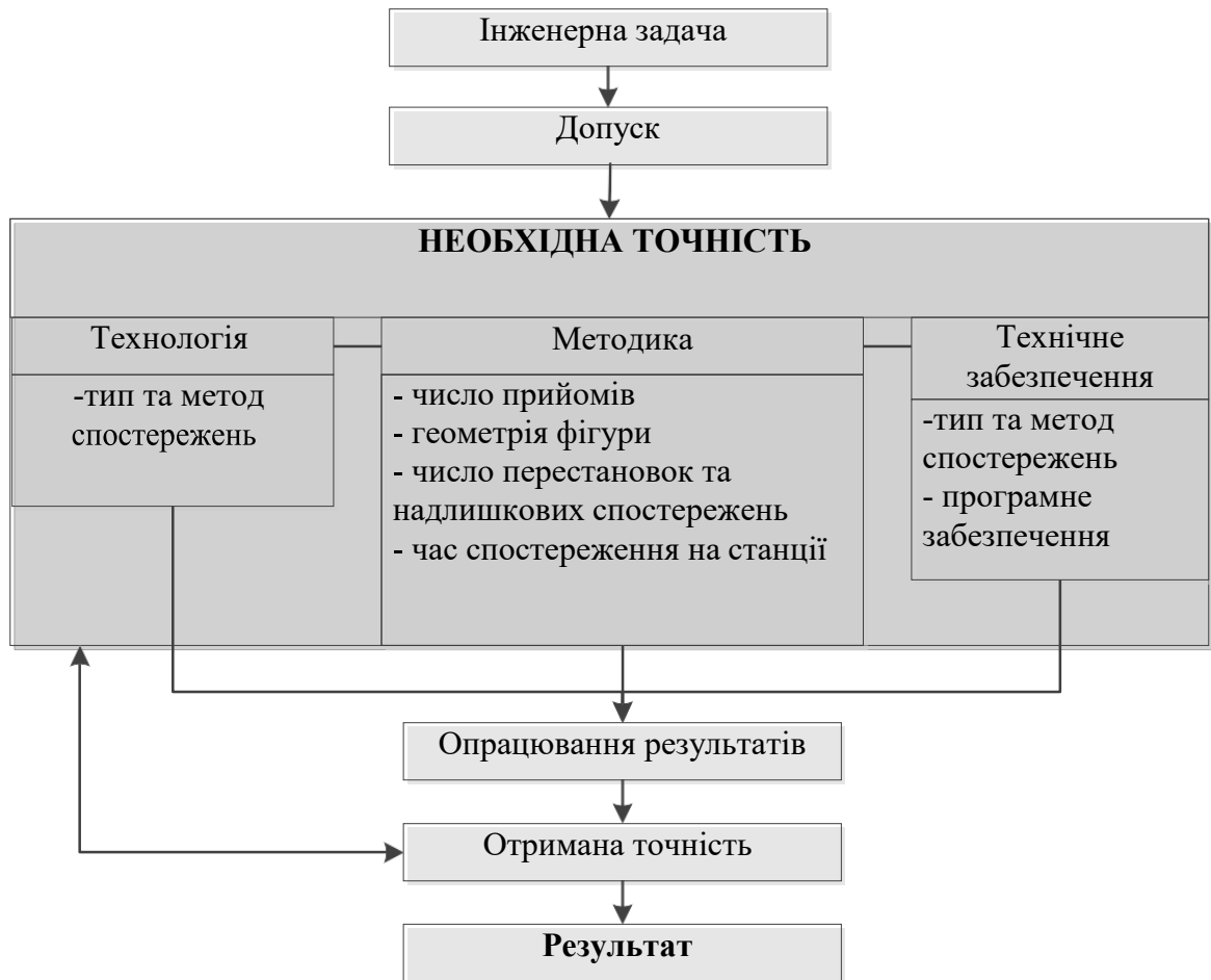
Рис. 2.9 Технологічна схема вирішення інженерно-геодезичної задачі [1]
