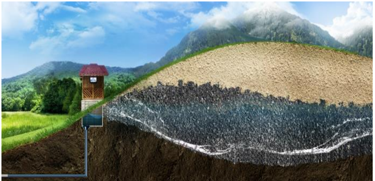
Рис. 3.1. Схема надходження води з джерела до каптажної споруди
