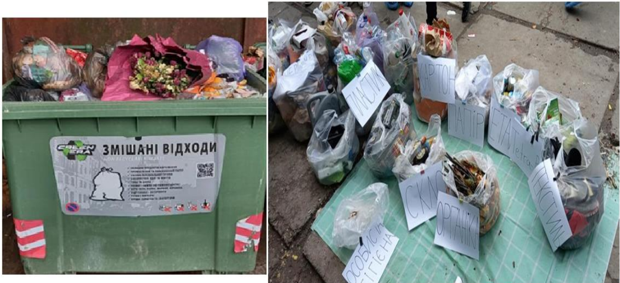
Рис. 3.7. Фото контейнера для змішаних відходів, обраного для дослідження та поділ його вмісту на окремі категорії
