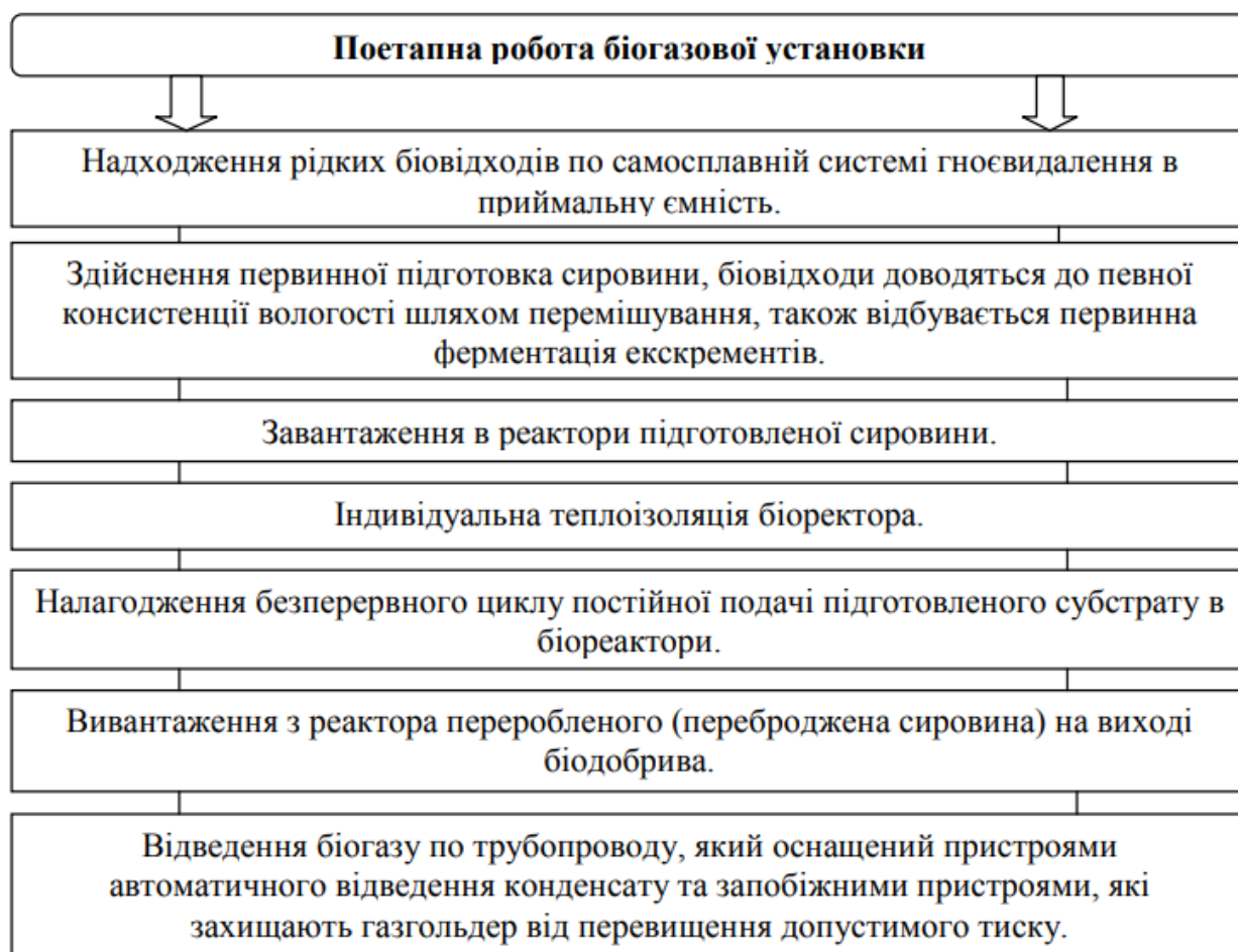
Рис. 1.7. Основні технологічні етапи роботи метантенка для одержання дигестату та біогазу за анаеробного бродіння [31].
