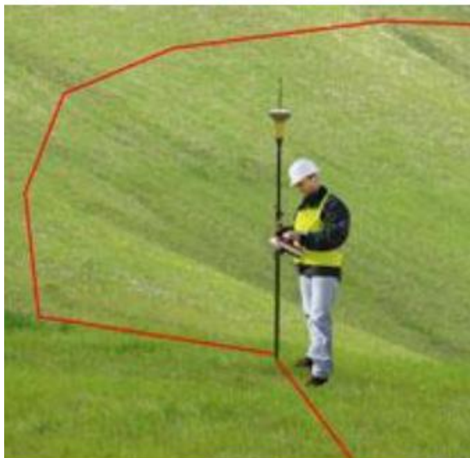
Рис. 3.19. Загальна схема перенесення проектних відміток межі прибережної захисної смуги в режимі RTK
