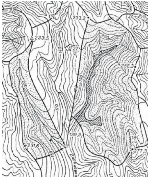
Рис. 2.17. Схема визначення водозбірної площі та площі затоплення за топографічною картою [27]
