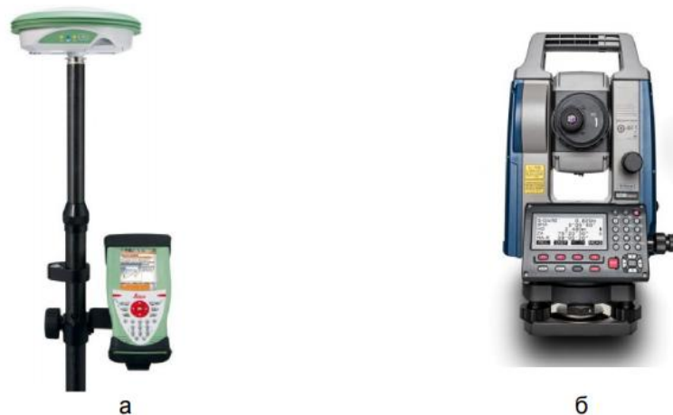
Рис. 3.18 Засоби для польових робіт: а – ГНСС приймач SokkiaGCX3; б – електронний тахеометр Sokkia-iAM-55
