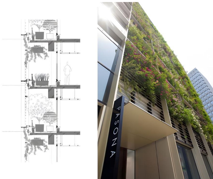
Рисунок 1.3 Конструктивна схема вертикального озеленення, Токіо, Японія
