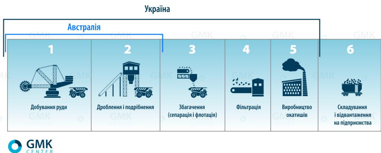
Рисунок 1.5 – Процес виробництва товарної залізорудної сировини в Україні та Австралії [40]
