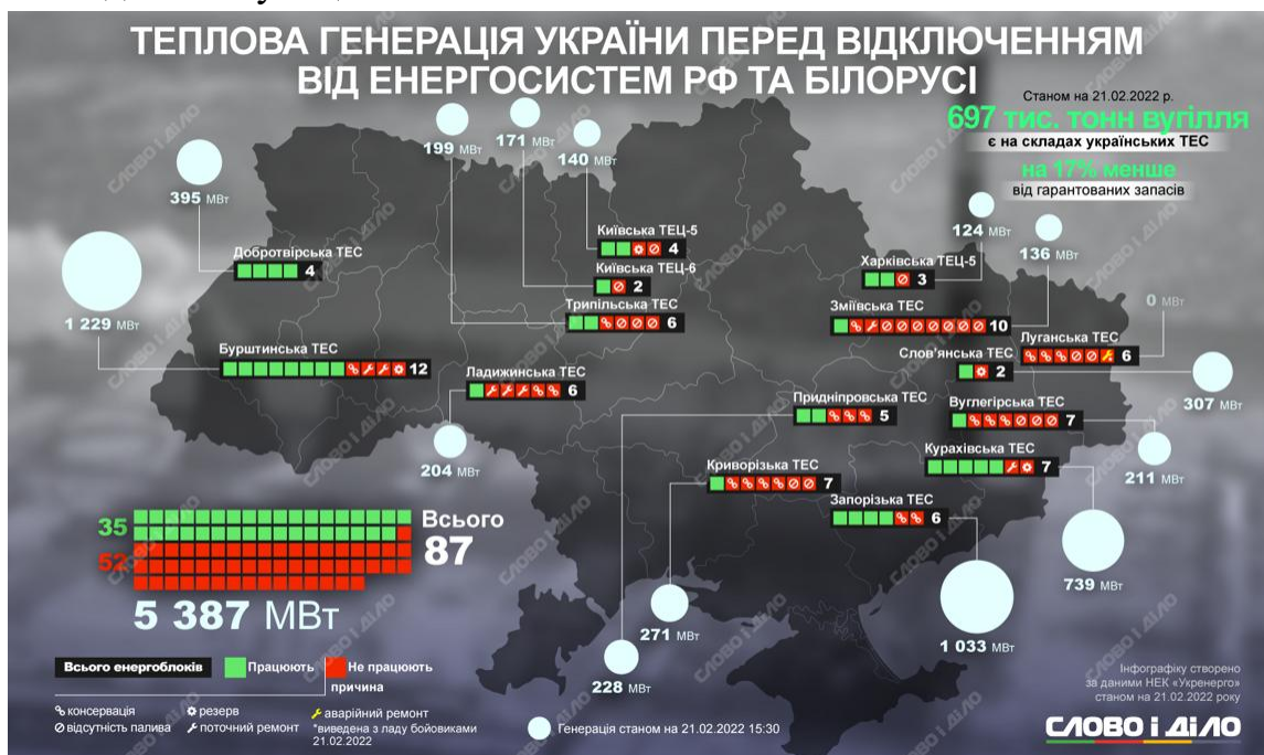
Рисунок 3.1 – Структура теплової генерації України за регіонами та оцінка запасів вугілля на складах ТЕС (станом на 21.02.2022).
