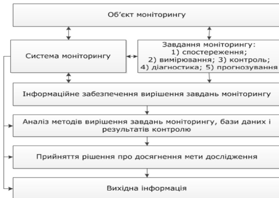
Рисунок 2.6 – Схематична модель процесу екологічного моніторингу об'єктів енергетичної інфраструктури [запропонована Запорожцем А. О.]
