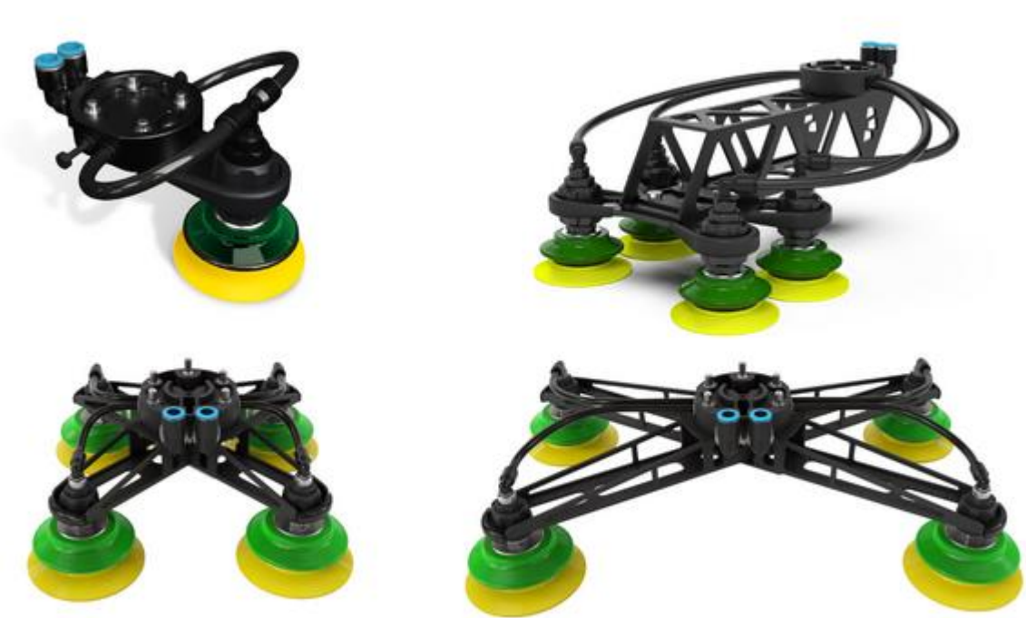
Рисунок 1.4 Різні види розміщення вакуумних присосок в залежності від типу вантажу, що переміщується
