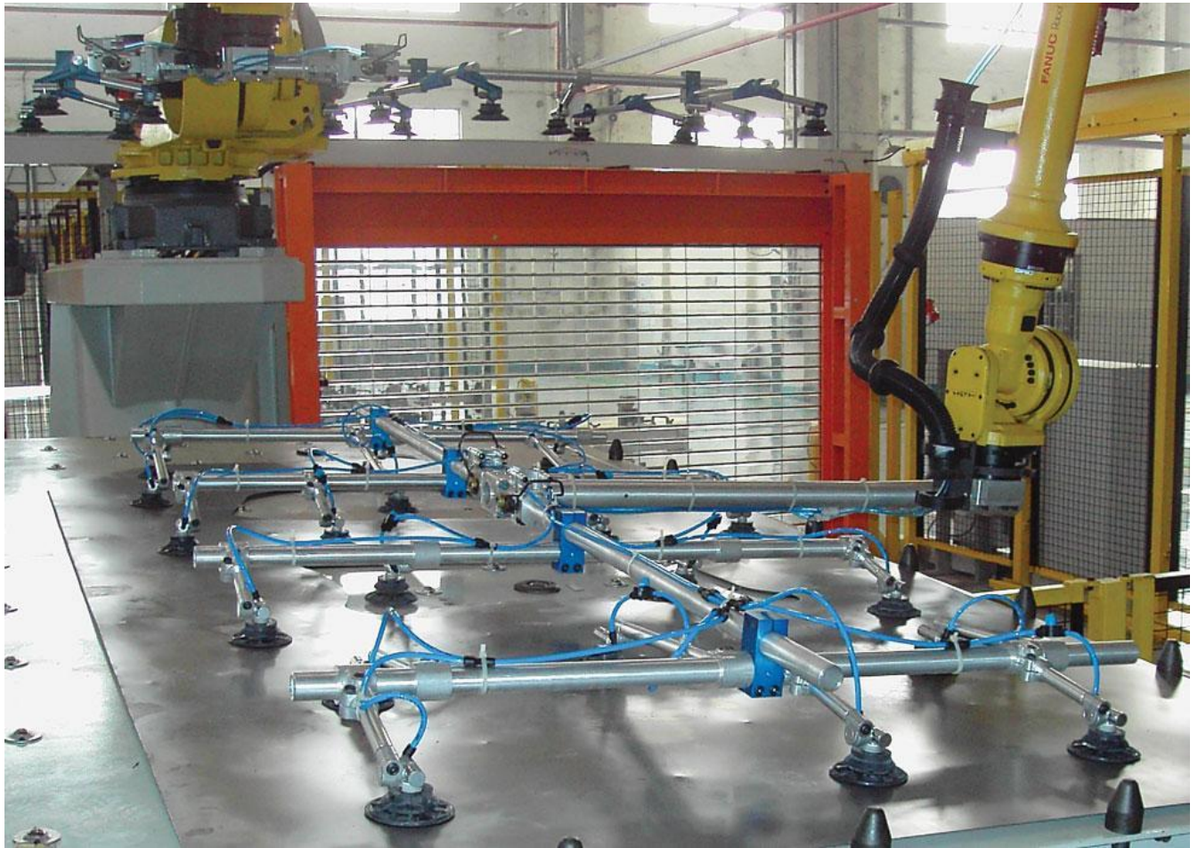
Рисунок 2.4 Асиметрична конструкція пневмо захвату створює додаткові нерівномірні навантаження на вакуумні присоски
