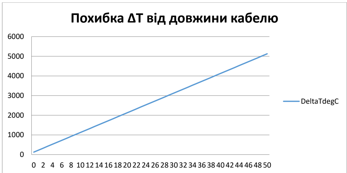
Рисунок 2.4 - Точність вимірювань у датчиках 1-Wire відносно довжини кабельної лінії
