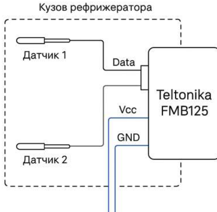
Рисунок 3.1 - Схема підключення 1-Wire-датчиків до трекера
