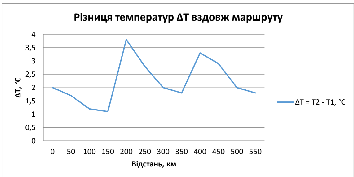
Рисунок 4.8 - Графік різниці \Delta T(x) температури за показами двох датчиків температури
