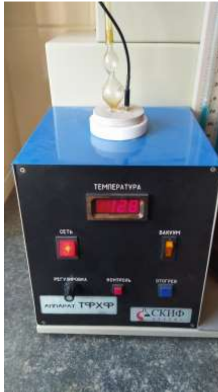
Рисунок 4.1 - Процес тарування сенсора температури DS18B20
