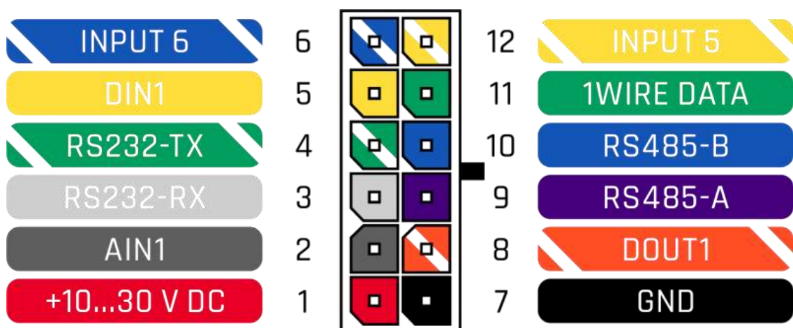
Рисунок 3.5 - Схема розташування виводів FMB125
