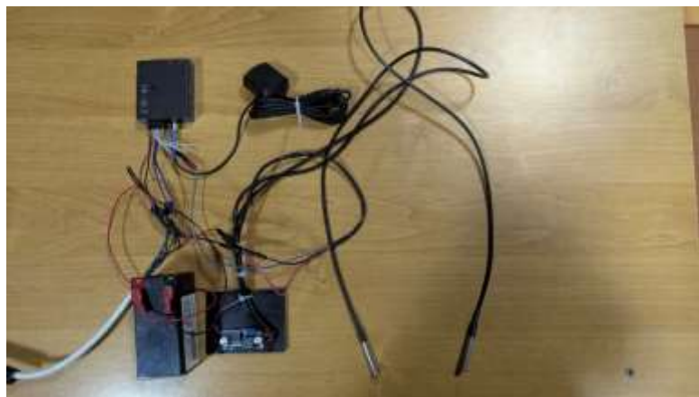
Рисунок 3.4 - Схема підключення сенсорів температури DS18B120
