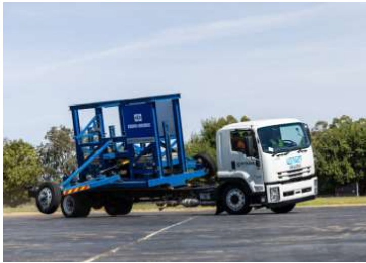
Рисунок 1.9 – Тестування електронної системи стабілізації ESC
