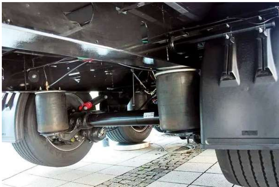
Рисунок 1.4 - Пневматична підвіска з повітряними пружними елементами
