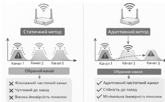
Рисунок 1.6 – Якісне порівняння статичного та адаптивного методів вибору каналу
