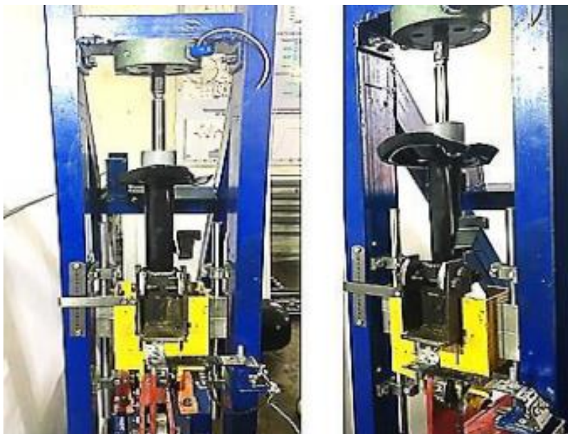
Рисунок 4.1. Амортизатор марки FoMoCo передньої підвіски Ford Focus 2, яка встановлена на динамометричному стенді
