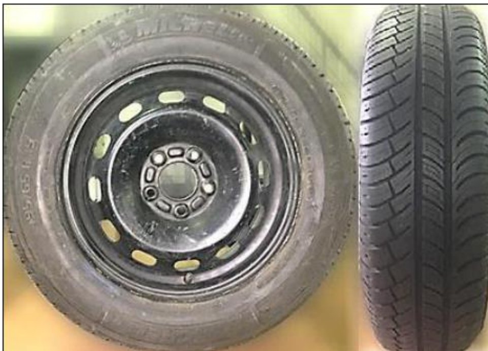
Рисунок 4.4 – Колесо з експериментальною еластичною літньою шиною марки MICHELIN 195/95 R15 91H
