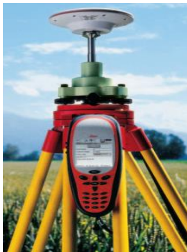
Рисунок 1.1 - Одностотний GPS-приймача Leica SR 20
