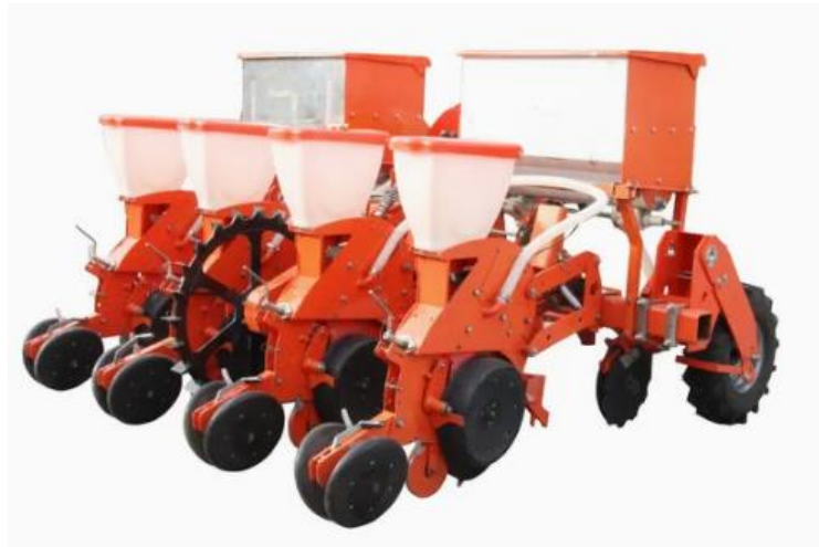
Рисунок. 1.6 Сівалка “Corn Planter and Seeder” з дисковим висівним апаратом періодичної дії «Geneva wheel».
