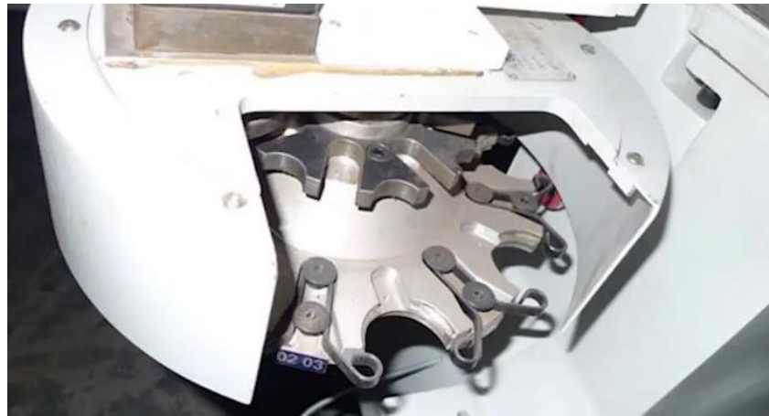
Рисунок. 1.4 Дисківий механізм періодичної дії (дискового механізму періодичної дії) в верстаті з ЧПК.
