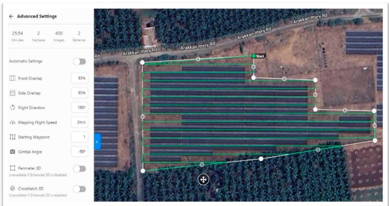
Рисунок 1.9 – Схема сітки, зображення: розгортання дрона [33]
