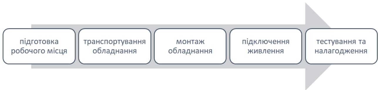
Рисунок 4.1 – Процес монтажу та налагодження програмно-апаратного комплексу інформаційної системи
