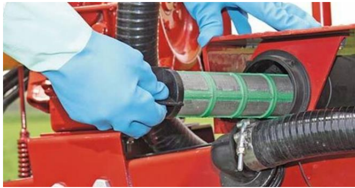
Рисунок 1.11 – Заміна фільтра в обприскувачі Hardi
