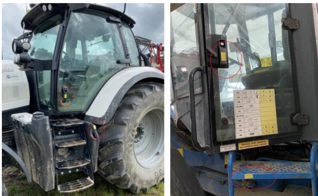
Рисунок 3.3 – Розміщення зразків паперу на кабіні та сходах тракторів, з якими агрегатується обприскувачі Matrot Maestria та Horsch Leeb (місце позначено червоним еліпсом - колом)
