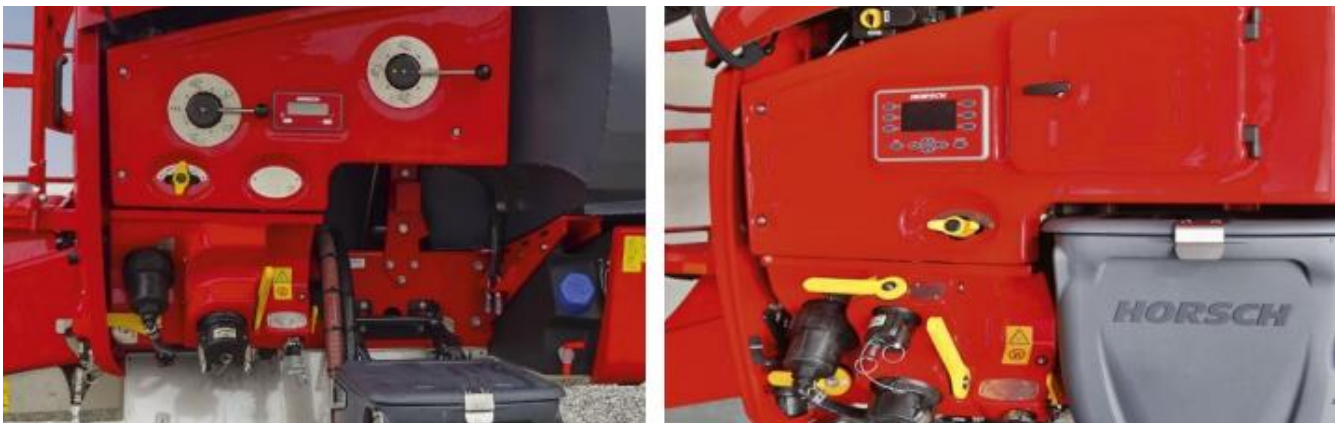
Рисунок 1.17 – Електронне та ручне керування наповненням та промиванням оприскувача HORSCH CCS Pro
