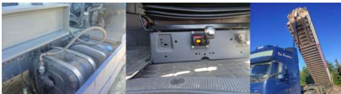
Рисунок 1.8 – Елементи гідрофікації вантажного автомобіля
