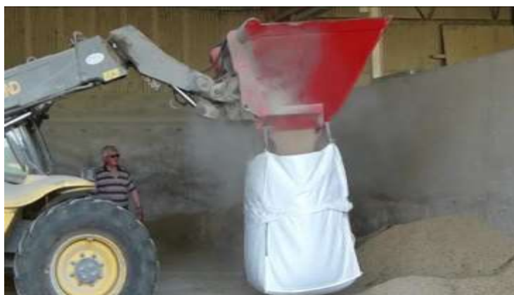
Рисунок 2.2 – Спосіб завантаження біг – бега
