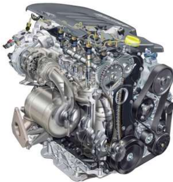
Рисунок 1.2 – Паливна система Common Rail двигуна Renault K9K
