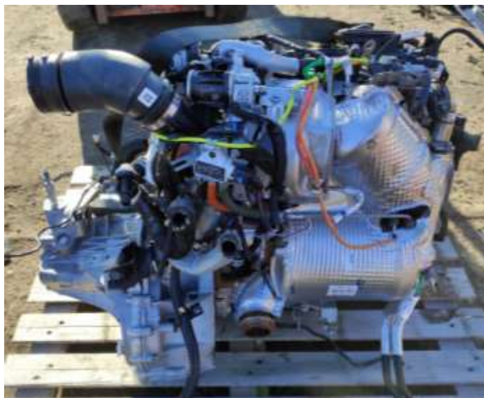
Рисунок 1.4 – Окиснювальний каталізатор DOC двигуна Renault K9K
