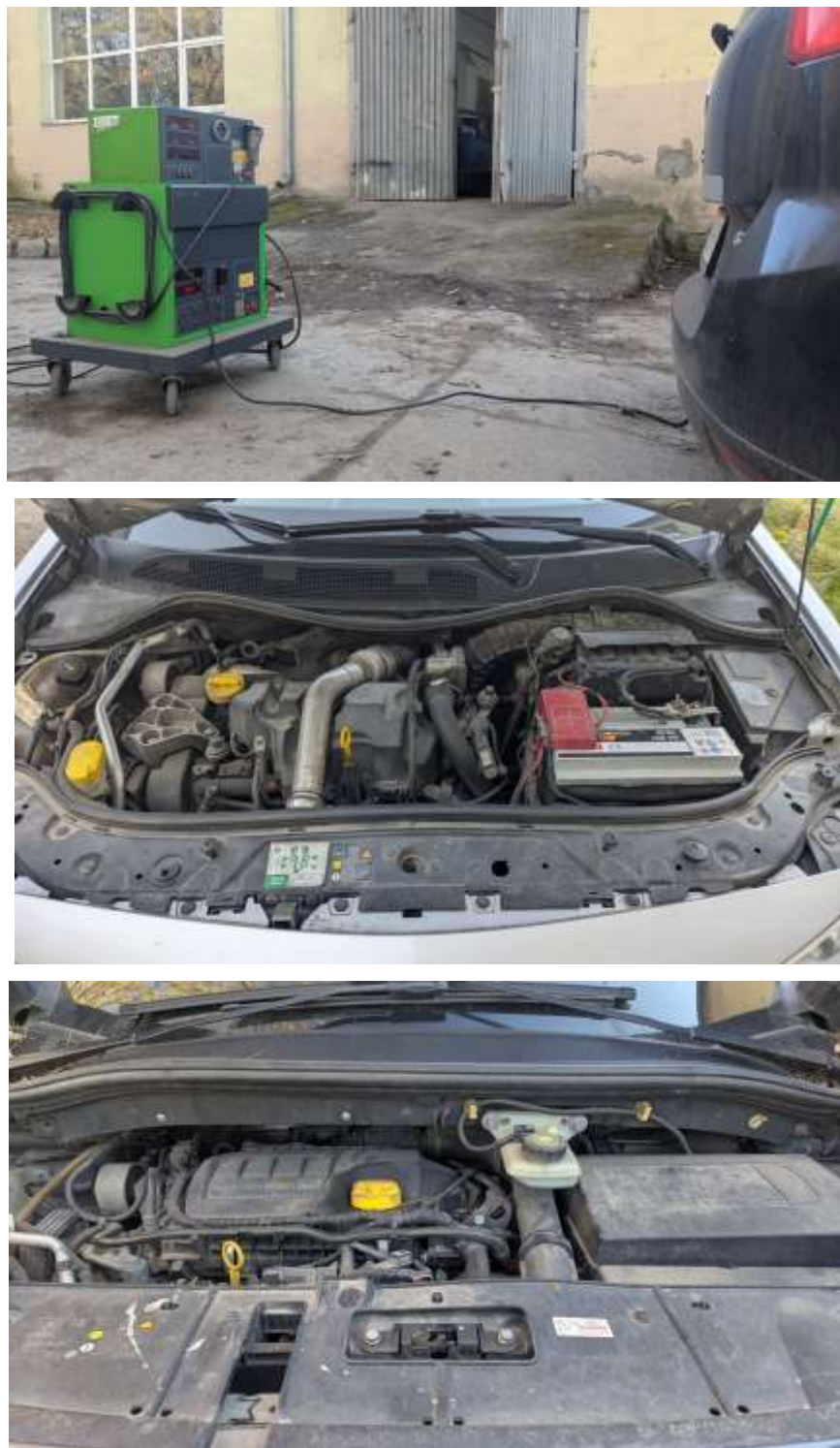
Рисунок 3.1 – Вимірювання димності вихлопних газів використанням мотортестера Bosch FSA 600
