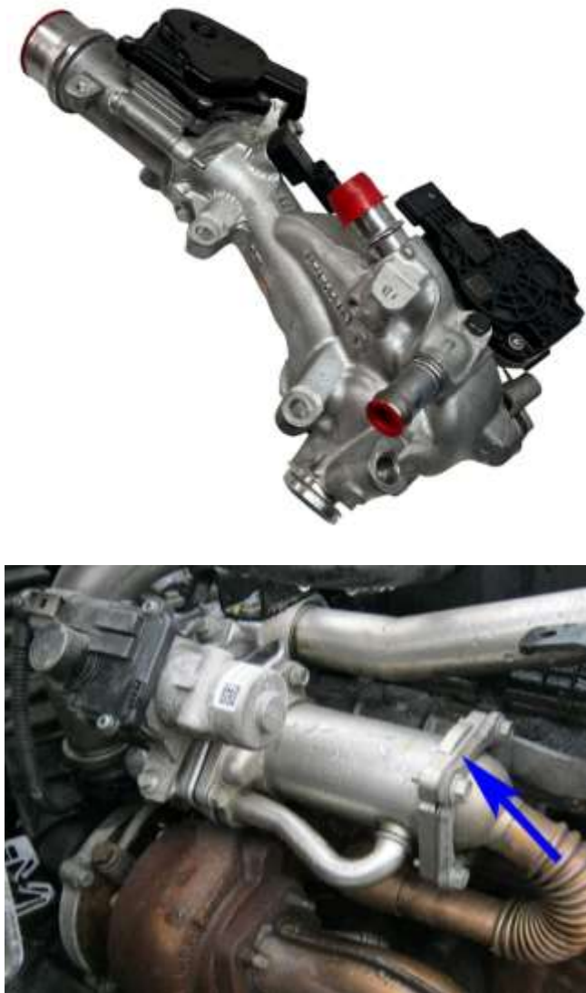
Рисунок 1.3 – EGR-система із електропневматичним клапаном і теплообмінником двигуна Renault K9K
