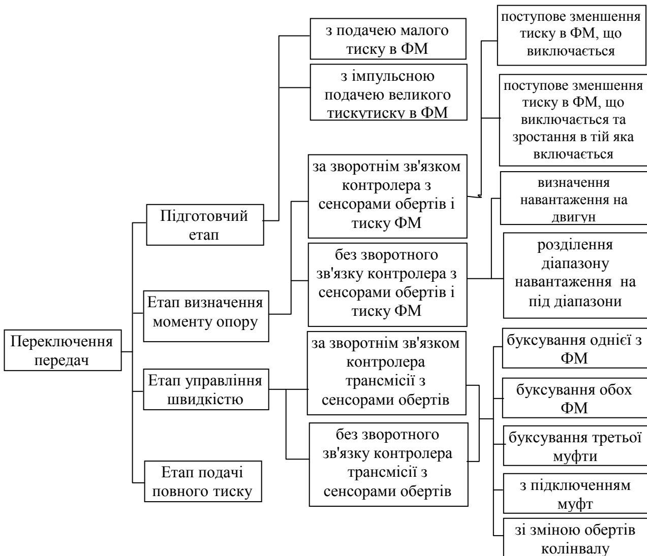
Рисунок 1. 8. Структура однопарного перемикавання передач з класифікацією можливих варіантів
